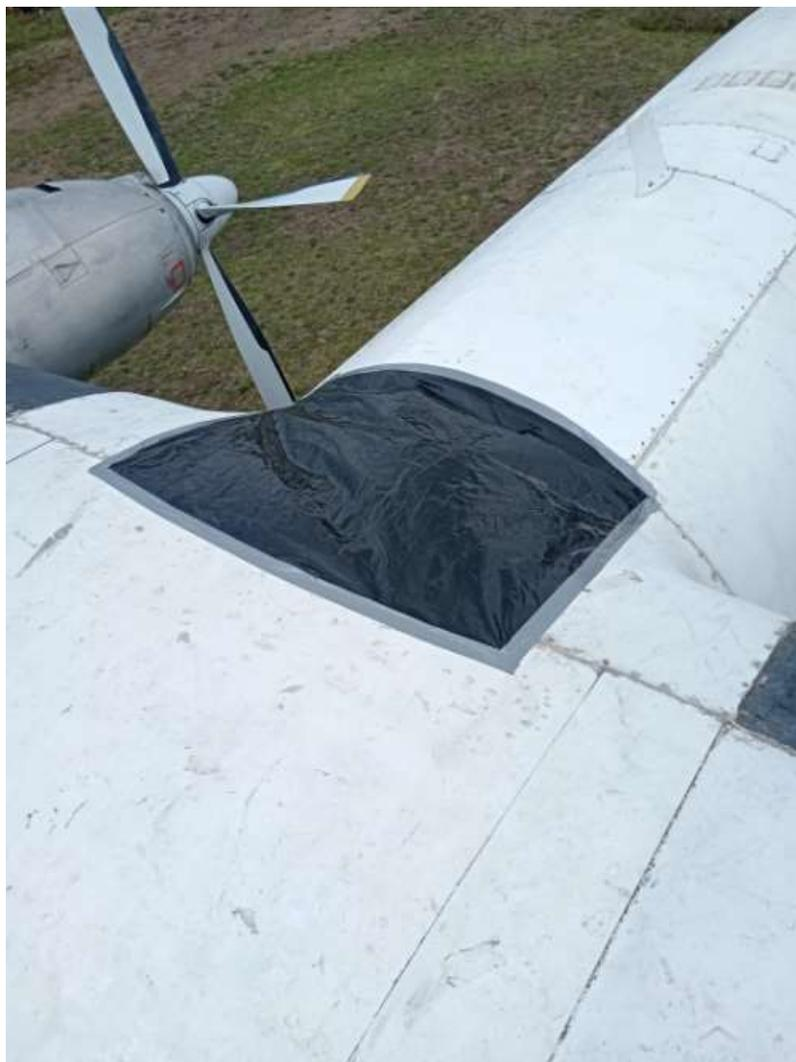
*Nota.* Recubrimiento con plástico del panel central delantero número 4 de la aeronave Fairchild FH-227.
