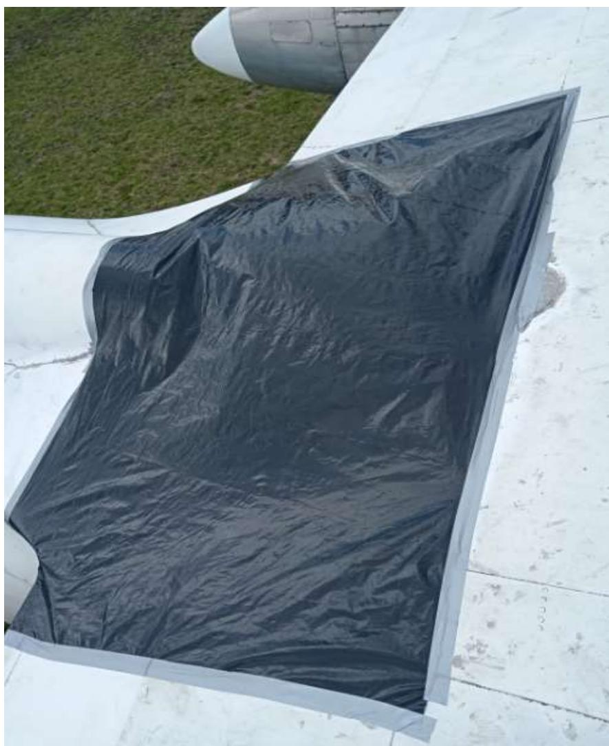
*Nota.* Recubrimiento con plástico en los paneles centrales número 1, 2 y 3 de la aeronave Fairchild FH-227.
