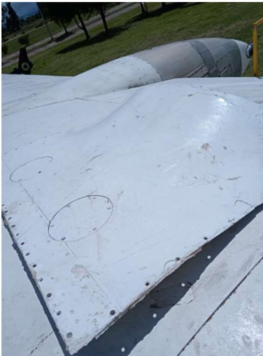
*Nota.* Panel número 4 removido de la parte central delantera de la sección de las alas de la aeronave Fairchild FH-227.
