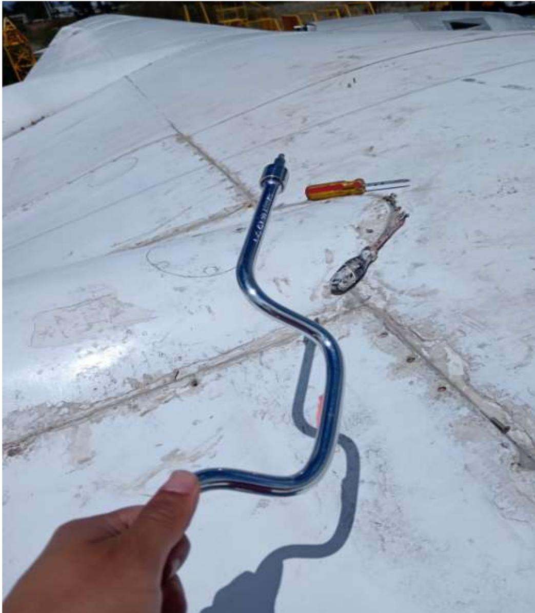
*Nota.* Herramientas que se utilizaron para la remoción de los paneles en la parte central superior de las alas de la aeronave Fairchild FH-227.
