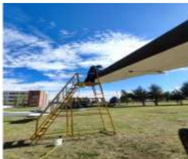
*Nota.* Estudiante realizando el procedimiento de lijado en la punta del ala derecha de la aeronave Fairchild FH-227.
