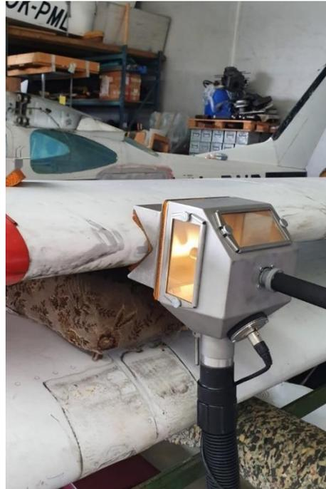
*Nota.* Este procedimiento se realiza mediante el uso de herramientas especiales con las cuales se aplica la temperatura adecuada para la remoción de la pintura.
