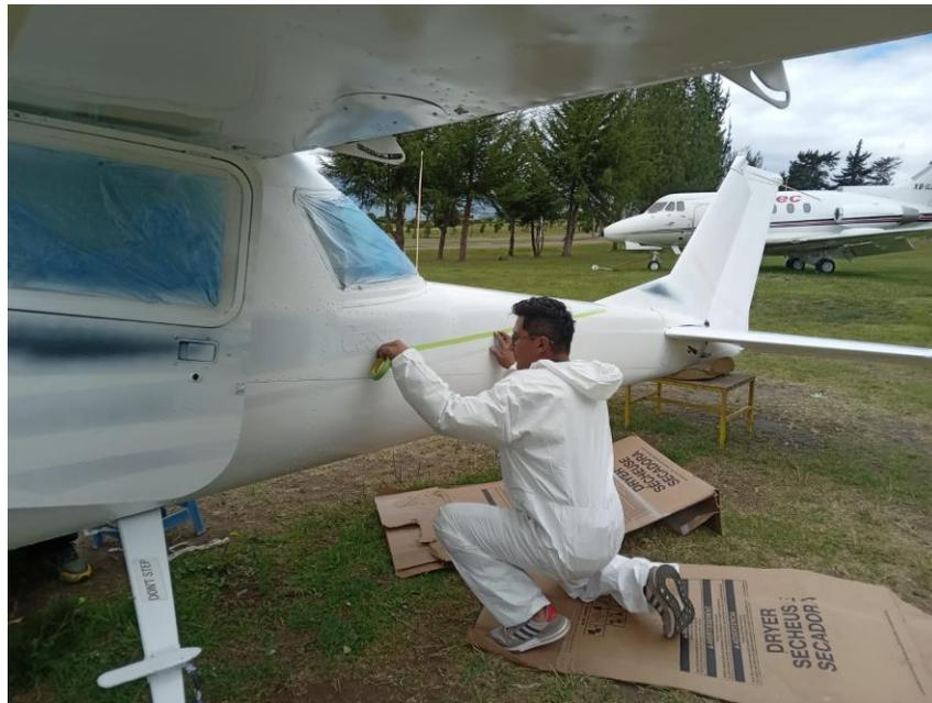
*Nota.* Se tiene que realizar este procedimiento, para proteger las ventanas el puerto Pitot, así como señalar por donde se pintaran las líneas y la matrícula de la aeronave.
