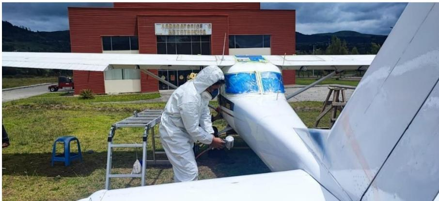
*Nota.* Se tiene que aplicar varias capas para que la pintura tenga un buen acabado.
