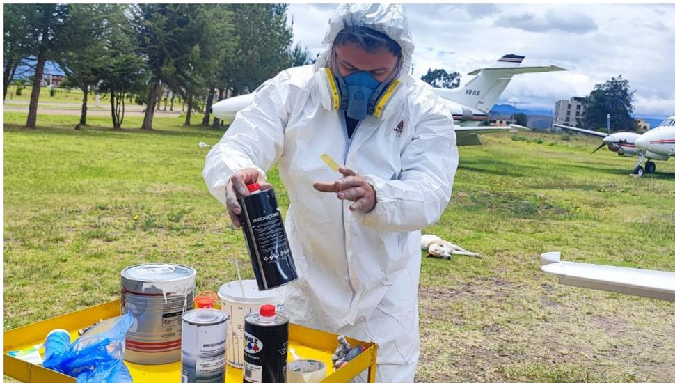
*Nota.* Este procedimiento se debe llevar a cabo momentos antes de realizar el pintado de la aeronave para evitar que la preparación se llegue a estropear.
