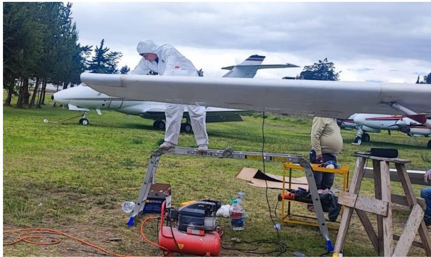
*Nota.* Este proceso se debe realizar con una buena iluminación para comprobar el estado de la estructura y ver si es necesario realizar algún procedimiento adicional, en este caso no se detectó corrosión.
