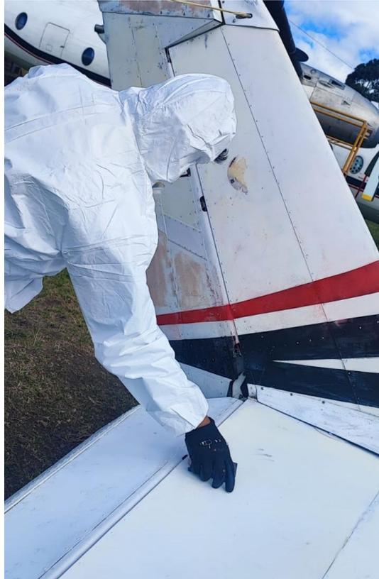
*Nota.* Este procedimiento se realizó mediante la selección del material adecuado como lo son dos lijas del número 180 y lija 240 que no comprometen la estructura del fuselaje.
