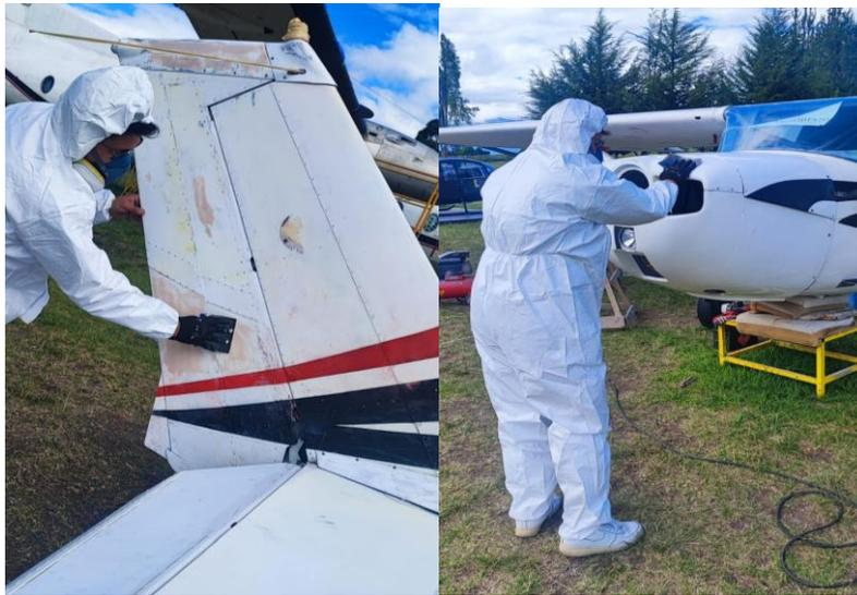
*Nota.* Este proceso se debe realizar correctamente, para que no queden residuos de la anterior capa de pintura para así asegurarse que el nuevo recubrimiento quede perfectamente.
