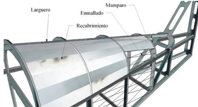
*Nota.* Componentes del fuselaje semi monocasco. Tomado de (FAA-H-8083-31 AMT Airframe Vol1,2012).
