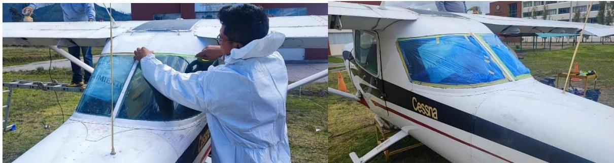
*Nota.* Se debe realizar este proceso para evitar que durante el procedimiento de la pintura esta llegue a afectar las ventanillas, la toma Pitot.
