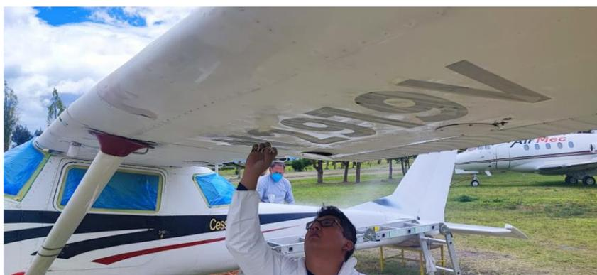
*Nota.* Es necesario marcar correctamente la matrícula de una aeronave para permitir su fácil identificación.
