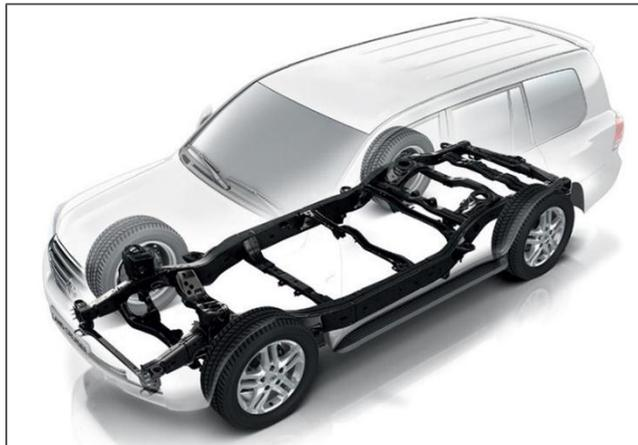
*Nota.* En esta figura se visualiza una carrocería de configuración en escalera. Tomado de (Central de repuesto TR, 2016)
