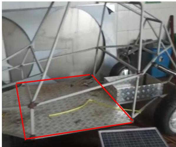
*Nota.* Se fabricó la base del bastidor con tubo cuadrado.
