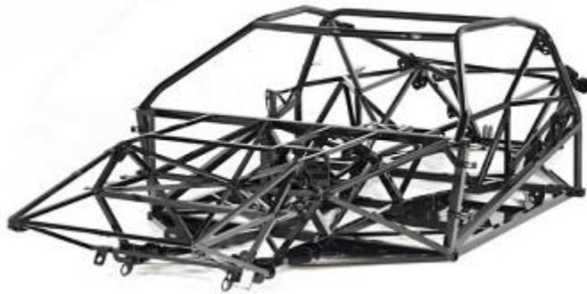
*Nota.* En la figura se observa un bastidor elaborado de varios tubos dando el nombre de bastidor tubular. Tomado de (Central de repuesto TR, 2016)
