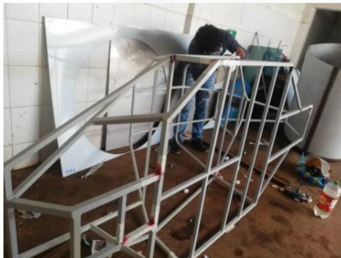
*Nota.* Una vez toda la estructura realizada sus respectivas uniones mediante puntos de soldadura, se refuerza cada unión con cordones de soldadura.
