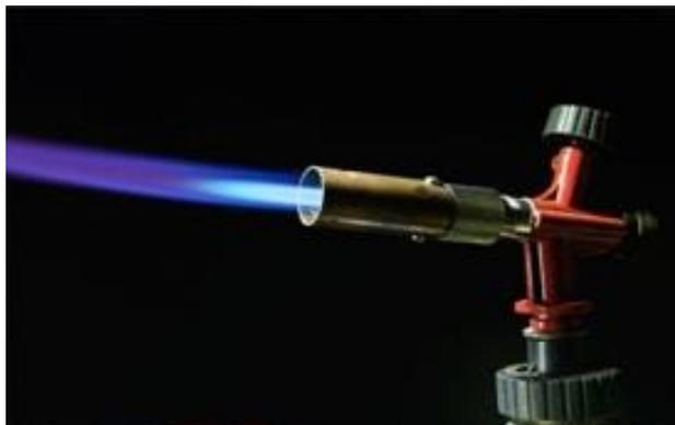
*Nota.* En la figura se puede observar un tipo de soldadura fuerte mediante una pistola que emite calor y funde el material a soldar. Tomado de (GM VYKON, 2017)
