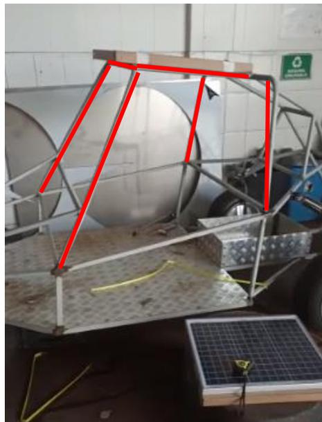
*Nota.* Se fabricó la parte de límites superiores de cabina de piloto y copiloto y el techo donde van alojados los paneles fotovoltaicos.
