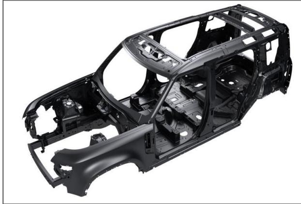
*Nota.* En esta figura se visualiza una carrocería de configuración monocasco. Tomado de (Diario motor, 2020)
