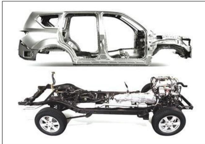
*Nota.* Esta figura representa un bastidor con configuración de carrocería separa. Tomado de (Senati, s.f.)
