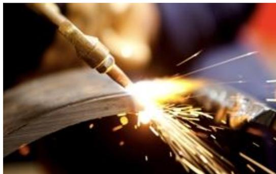
*Nota.* En la figura se puede observar un tipo de soldadura oxiacetilénica. Tomado de (GM VYKON, 2017)
