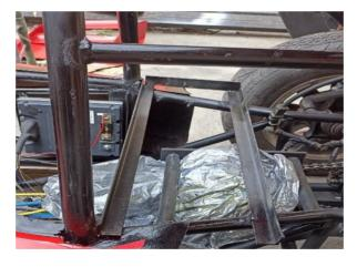
Nota. En la figura 16 se observa la nueva base que abarcara el nuevo pack de batería.
