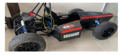
Nota. En la figura 13 se observa el prototipo con la antigua batería ion de litio.
