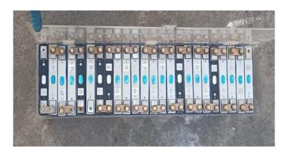
Nota. En la figura 22 se observa la conexión en serie de las celdas y la suma de todos los voltajes, un total de 80 V.
