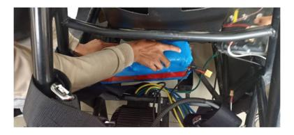
Nota. En la figura 14 se observa la batería ion de litio que será remplazada por la batería de litio ferro-fosfato.
