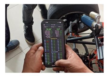
*Nota.* En la figura 27 se observa los datos que se obtiene mediante el BMS y los resultados de carga de cada celda de la batería.
