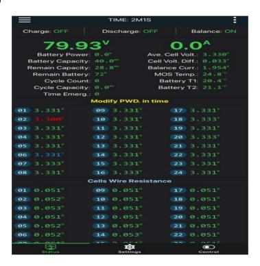
Nota. En la figura 28 se observa el software donde muestra los voltajes de cada celda de la batería y sus características.
