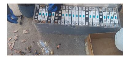
Nota. En la figura 21 se observa la conexión en serie de las celdas con placas de cobre y tornillos para su ajuste.
