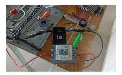
Nota. En la figura 26 se observa la instalción del BMS con sus respectiva conexión.
