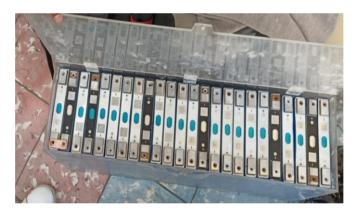
Nota. En la figura 20 se observa la base de acrílico y la colocación de las celdas de batería para su respectiva conexión.
