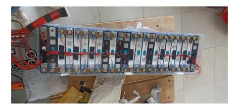
Nota. En la figura 25 se observa la conexión de cables del BMS a cada uno de los bornes de la batería.
