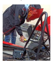
Nota. En la figura 15 se observa el proceso de soldadura SMAW para la nueva base del pack de baterías, que se va instalar en el bastidor.
