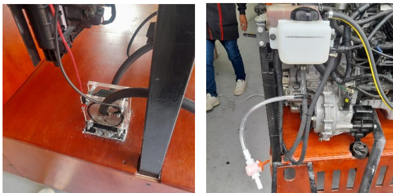
Conexión de mangueras del sistema de hidrogeno
