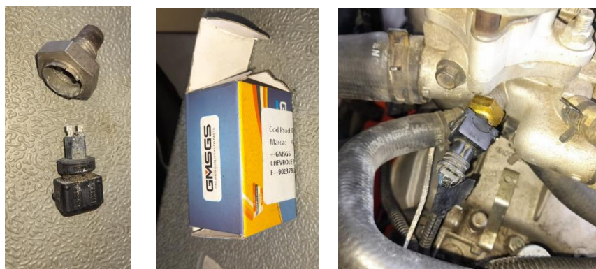
Reemplazo de sensor de temperatura
