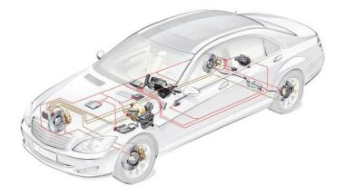
Nota. Componentes del sistema de frenos del vehículo. Tomado de (Gomez, 2020).
