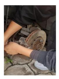
Montar las pastillas de freno: Introducimos la pastilla exterior en el soporte de la pinza, así como la pastilla del lado del pistón en la pinza de freno. Colocamos la pinza de freno sobre su soporte.
