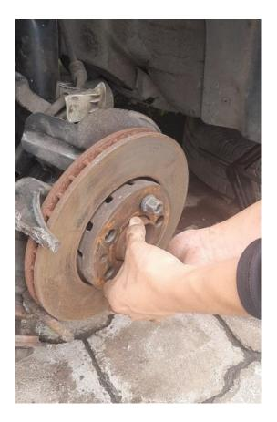
Nota. Se colocó dos pernos de la rueda para poder sujetar el disco y poder colocar la mordaza de freno y dejar instalado el freno.
