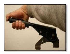
El sistema de freno de estacionamiento es totalmente mecánico. El conductor aplica los frenos de estacionamiento ya sea mediante una palanca o presionando un pedal. Por lo general, los frenos de estacionamiento, funcionan solamente en las ruedas traseras; no obstante, usan cables accionados por palancas para llevar la fuerza aplicada por el conductor a las ruedas y no a un sistema hidráulico.
