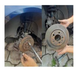
Comprobar el cubo de la rueda: Comprobamos si la superficie presenta corrosión o algún otro daño, que la rosca no presente daños, giramos el cubo de la rueda para saber el juego del rodamiento de la rueda sea uniforme. Limpiamos la superficie del cubo de la rueda con la herramienta adecuada. Retirando las impurezas y los restos de corrosión.
