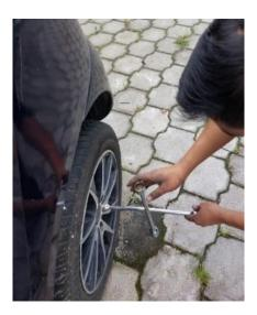
Nota. Se debe colocar la rueda y ajustar moderadamente, y cuando la rueda está asentada se debe ajustar completamente para la seguridad del mismo.
