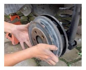
*Nota.* Cuando ya se colocan todos los componentes del sistema y luego de dar un mantenimiento del mismo se debe montar nuevamente el tambor del freno.
