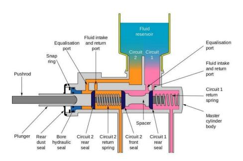
Nota. Elementos que conforman la bomba del sistema de frenos del vehículo. Tomado de (Gomez, 2020).
