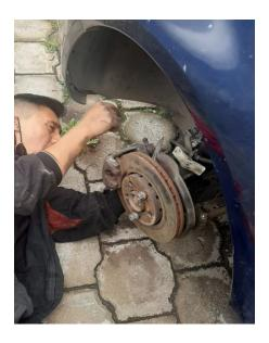
Regresar el pistón a su posición presionando hacia atrás totalmente el pistón de freno con la herramienta adecuada. Comprobamos si el guardapolvo del pistón está colocado correctamente y que no presente daño, una vez que presionamos el pistón debemos vigilar el nivel del líquido de frenos en el depósito, previamente vaciado el depósito.
