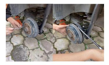
Ya retirado el tambor, revísalo: Identificamos si el tambor necesita ser rectificado o reemplazado así podemos asegurar una buena evaluación, antes de desarmar los resortes y pala para el autoajuste del freno de estacionamiento. Tomamos una foto con un cámara detallado dónde se encuentra todo antes de que quitemos los componentes.
