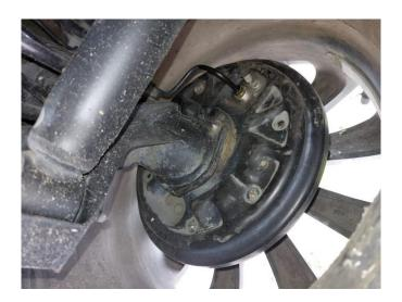
Retirar ambos tapones de protección de los pernos guía: Se observa si los tapones de protección o los manguitos de suspensión se encuentran defectuosos o presentan algún daño. Si ha entrado agua o suciedad, puede haber provocado corrosión en los pernos guía, lo que provocaría un mal funcionamiento de la pinza de freno.
