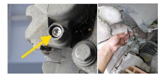
Retirar la pinza de freno de su soporte: Para lo cual, tomamos de la pinza de freno y tiramos hacia atrás, sacando de la pinza de freno la pastilla interior y la exterior. Comprobamos el desgaste de las pastillas de freno, ya que una gran diferencia en el desgaste de las pastillas de freno indicaría que el funcionamiento de la pinza de freno no es el correcto.
