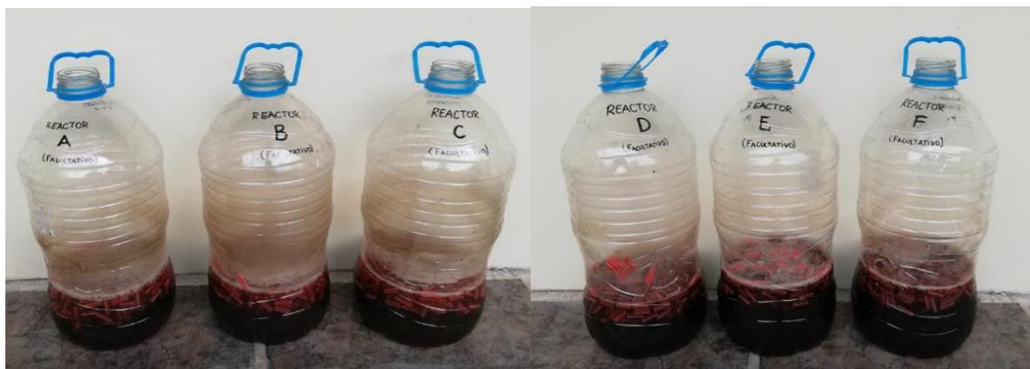
*Nota.* Se observa los reactores escalados a nivel de laboratorio de los distintos experimentos. Reactores A, B y C con muestra de lixiviado 1 (P1-2). Reactores D, E y F con muestra de lixiviado 2 (P9).
