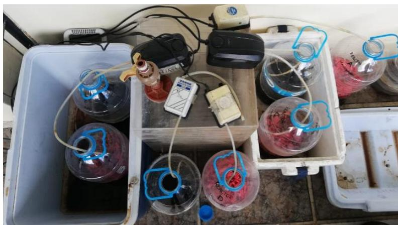
*Nota.* Los reactores se dispusieron en un espacio abierto, conectados con una fuente de aireación (aireadores mecánicos con difusores de aire), para poder generar movimiento en los sorbetes y desplazamiento de aire en todo el contenedor con lixiviado.
