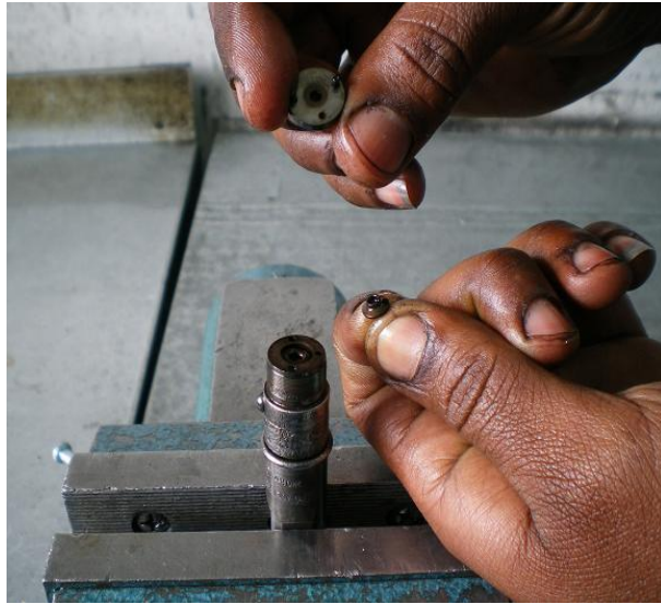
Figura 5.11 Montaje del espaciador y la pieza de levantamiento
