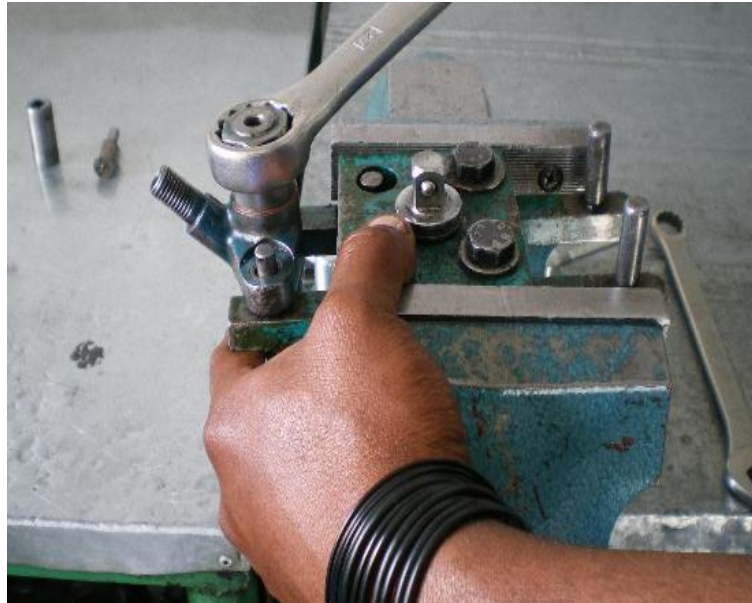
Figura 5.6 Desmontaje de la tuerca y la tapa
