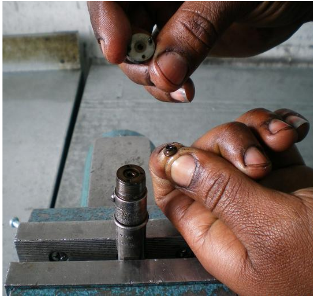
Figura 5.4 Desmontaje del espaciador
