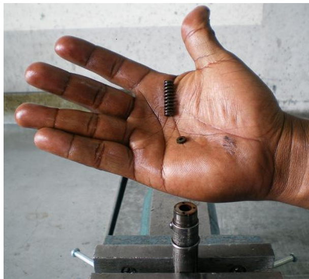
Figura 5.10 Montaje del muelle y la arandela de presión
