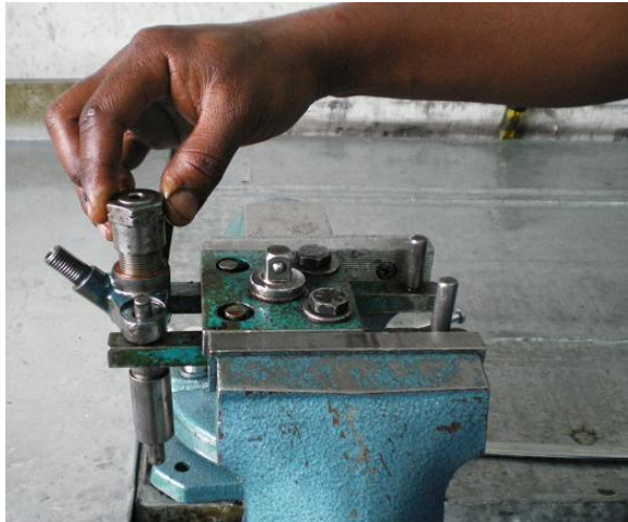
Figura 5.15 Montaje de la arandela y tuerca de la tapa
