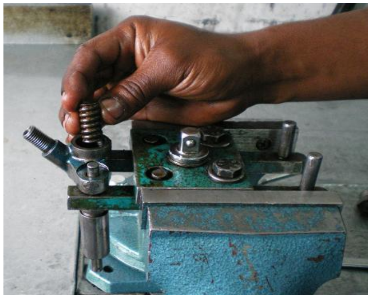
Figura 5.14 Montaje de la barra de empuje y el resorte
