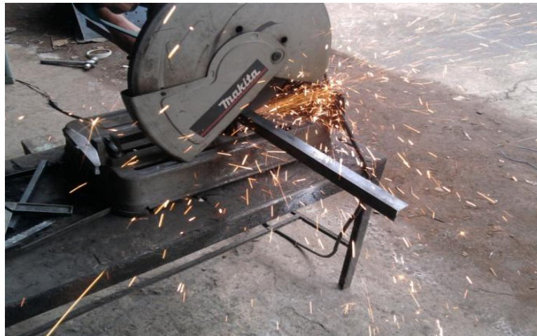
Figura 4.5 Corte de los ángulos.
