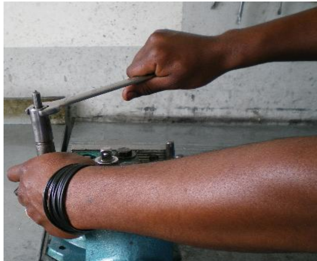
Figura 5.2 Desmontaje de la tuerca de retención
