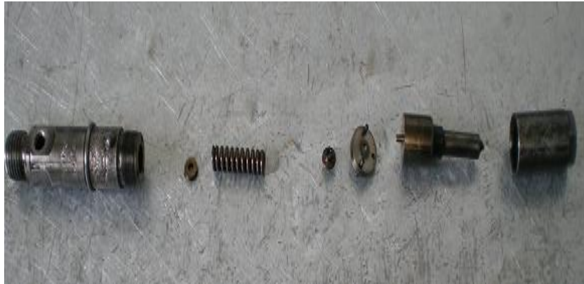
Figura 5.8 Limpieza de los componentes
