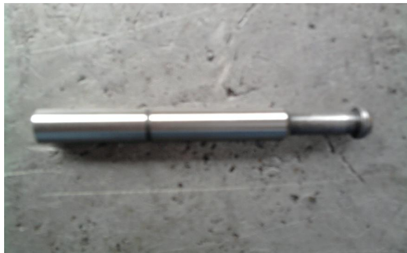
Figura 4.9 Pistón de bombeo terminado.
