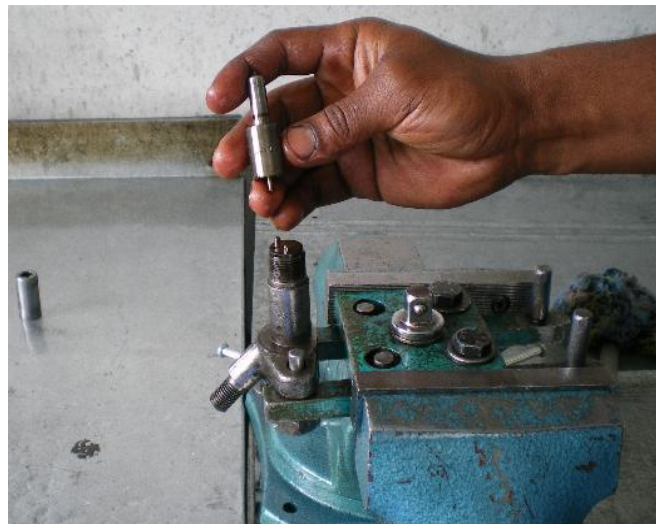
Figura 5.3 Desmontaje de la tobera
