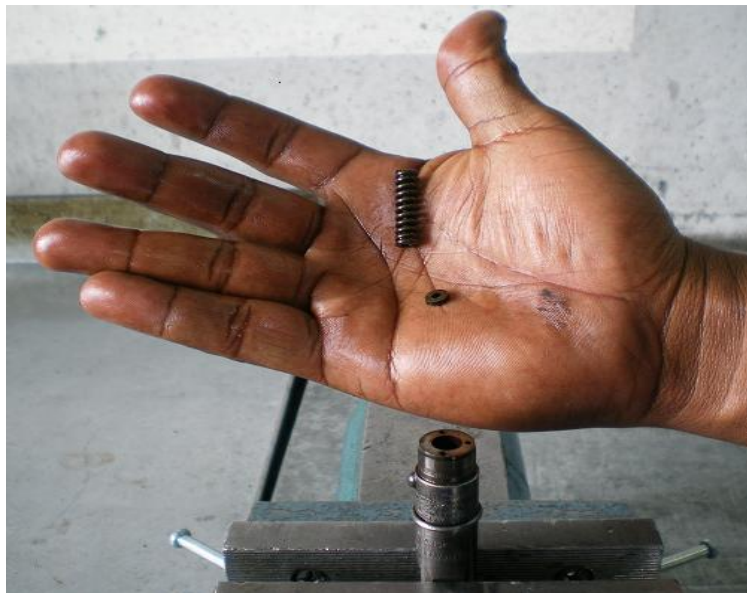
Figura 5.5 Desmontaje del muelle y arandela
