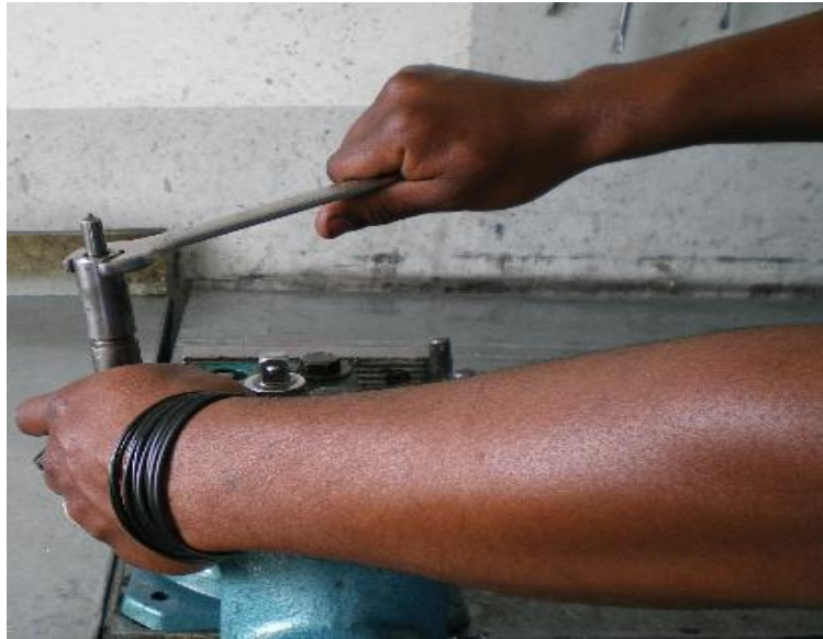
Figura 5.13 Montaje de la tuerca de retención
