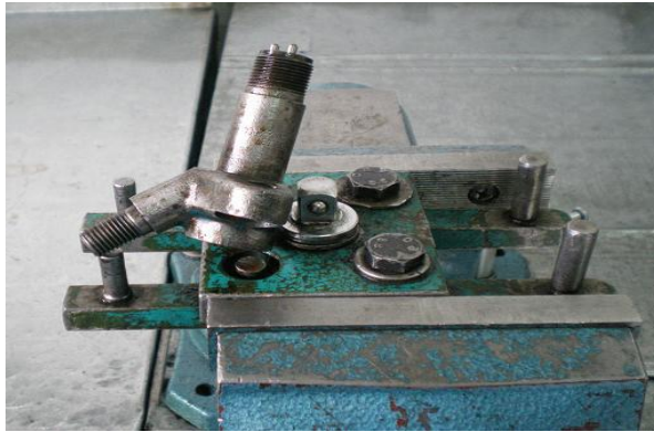
Figura 5.9 Montaje del porta inyector
