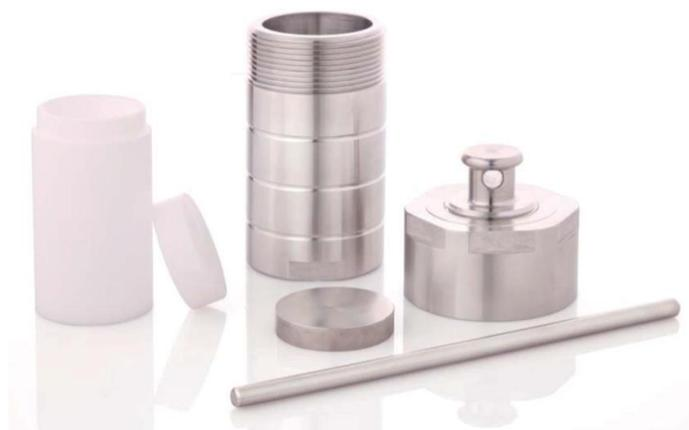
*Nota.* El gráfico representa un autoclave de acero inoxidable con cápsula de teflón. Tomado de *Estudio de partículas de carbono obtenidas mediante el método hidrotérmico* (p.44), por M. F. Andrade, 2022, Escuela Politécnica Nacional.
