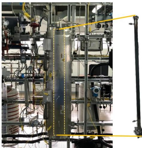
*Nota.* Estructura del reactor tubular ubicado dentro de la camisa calefactora del horno.
