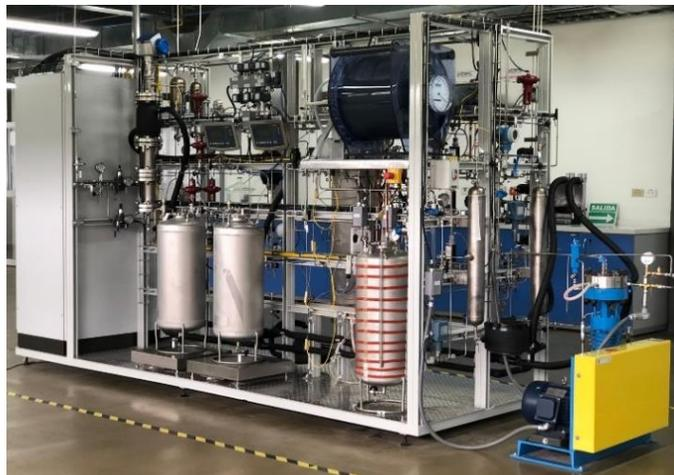
El reactor tubular es de acero inoxidable con un diámetro interior y exterior de 37.5 mm, y 48.1 mm, respectivamente. El reactor se colocó dentro de la cámara del horno, como se muestra en la Figura 9.
