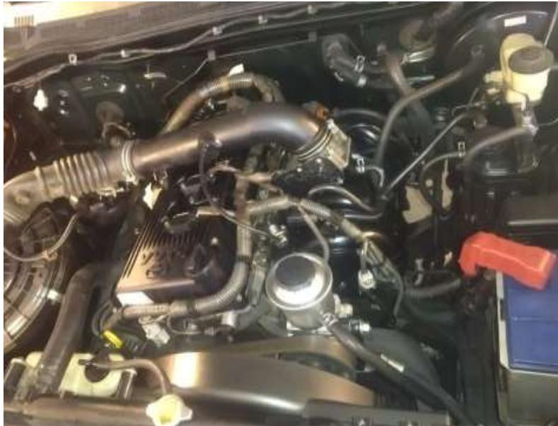
*Nota.* El gráfico muestra un motor Toyota 2TR de combustión interna, que forma parte de un vehículo.
