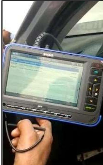
*Nota.* El gráfico muestra el escaneo del sistema electrónico con el escáner G-Scan 2.
