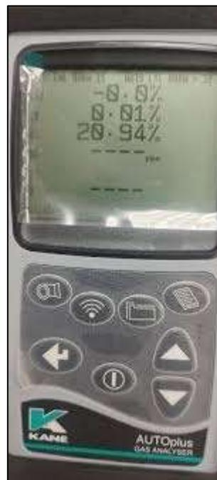
*Nota.* El gráfico muestra la pantalla del analizador de gases, donde se verificó que el motor trabaje dentro de sus parámetros adecuados.
