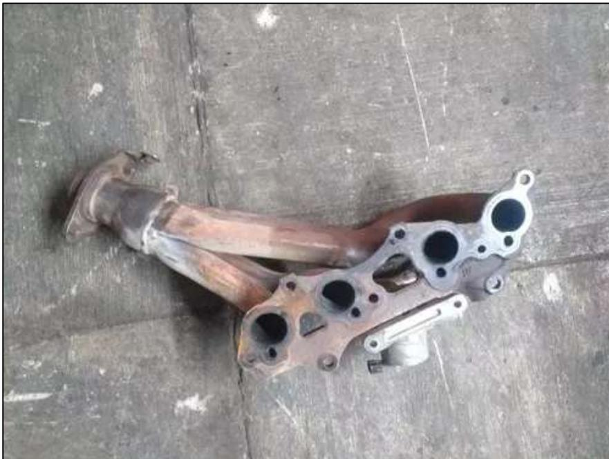
*Nota.* El gráfico muestra la inspección del múltiple de escape del motor Toyota 2TR.
