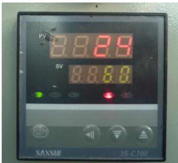
**Figura.6.2. pantalla del pirómetro**
