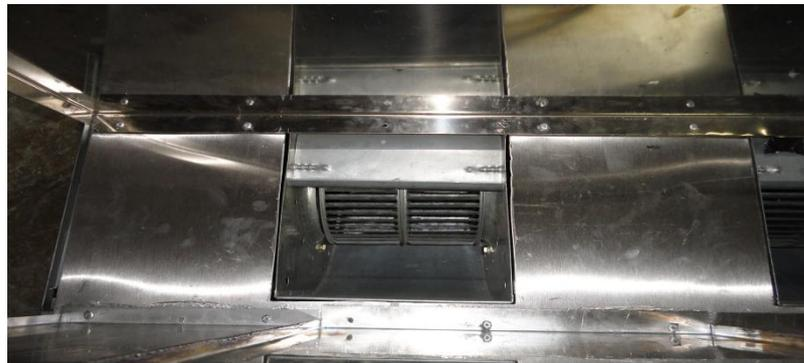
**Figura. 5.1. Ventiladores centrífugos de nuestro horno**
