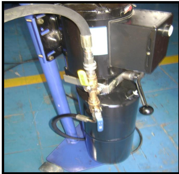
Figura 3.1 Centralita de mando electrohidráulico.
