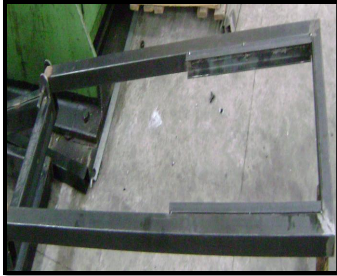
Figura 4.13 Soldadura de rieles.
