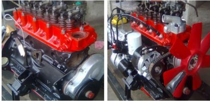
Figura 3.8 MCI armado completamente
