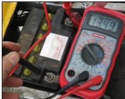
Figura 4.8 Comprobación de la batería con el multímetro
