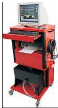
Figura 4.38 Analizador de gases
