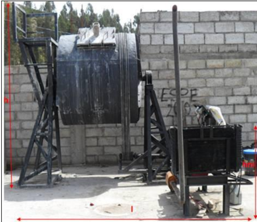
Figura 4.1 Dimensiones del molino en vista frontal
