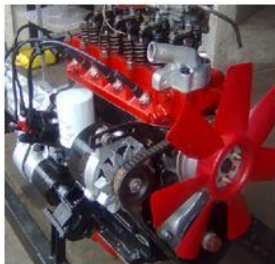
Figura 7. MCI armado completamente
