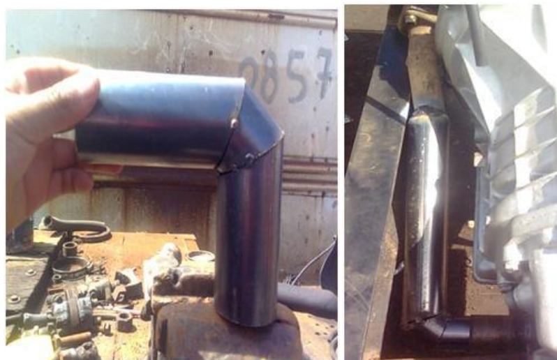
Figura 3.42 Construcción del múltiple de escape
