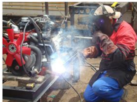
Figura 3. 36 Soldadura de la base para la batería
