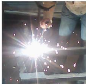
Figura 3.18 Unión de los ángulos por suelda SMAW
