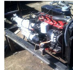
Figura 9. Motor montado en la base
