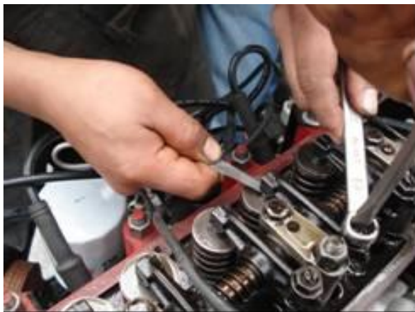
Figura 4.3 Galga o laminilla de calibración
