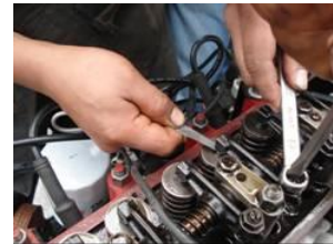
Figura 15. Galga o laminilla de calibración
