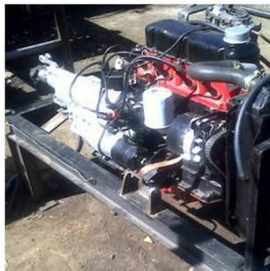
Figura 3.24 Motor montado en la base
