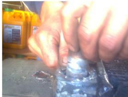
Figura 3.38 Cambio de toma de agua del radiador
