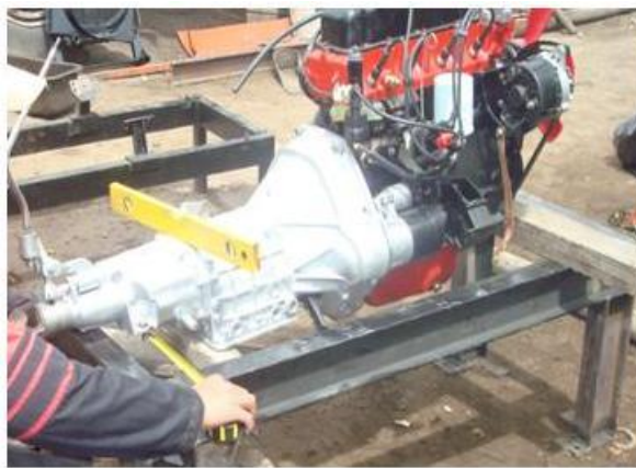
Figura 3.21 Medición de las bases del Motor
