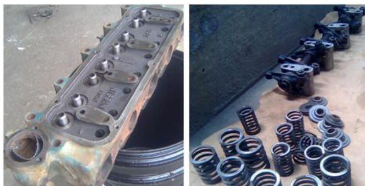
Figura 3.3 Desarmado de partes a reemplazar
