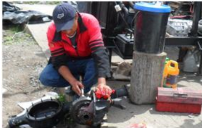
Figura 3.67 Limpieza y comprobación del diferencial
