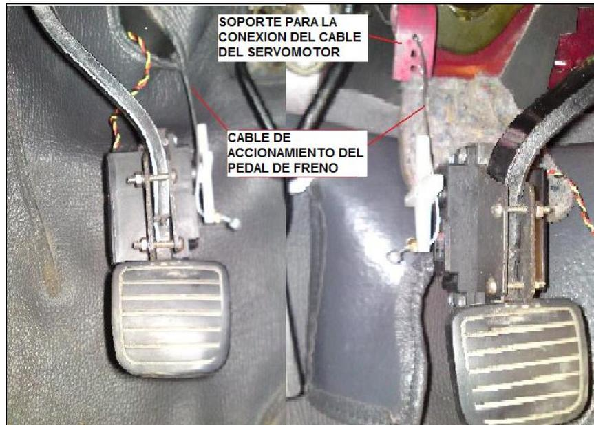
Figura 4.7 Cable de accionamiento del pedal de freno.
