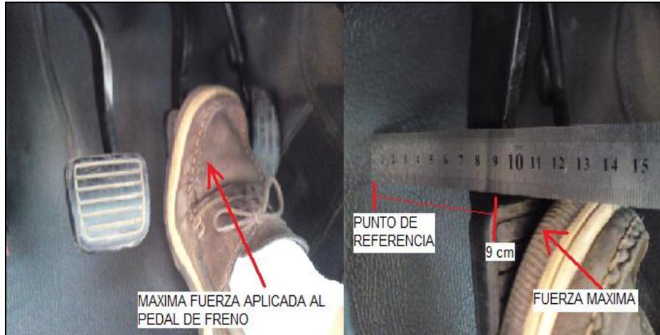
Figura 4.15. Aplicación de una fuerza máxima sobre el pedal de freno.
