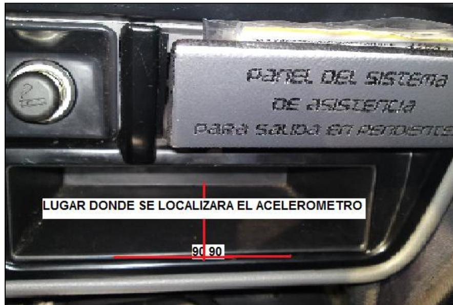
Figura 4.17 Ubicación correcta del acelerómetro.
