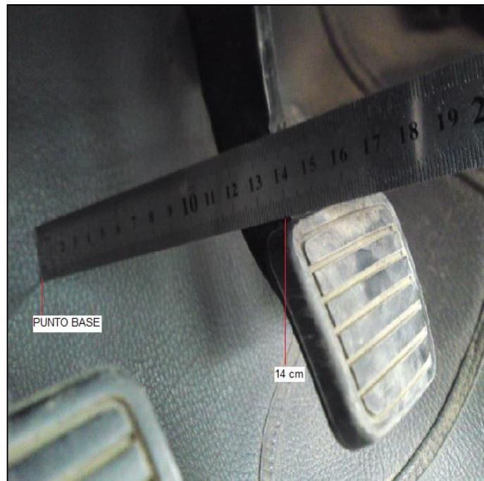
Figura 4.14 Distancia medida entre el pedal de freno y un punto base.
