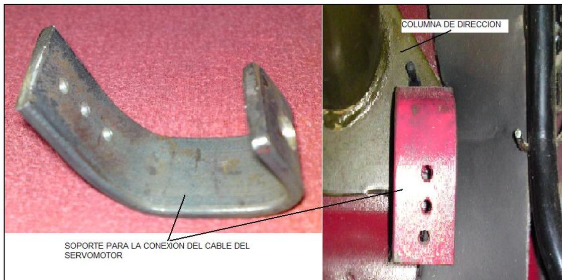
Figura 4.3 Estructura para la conexión del servomotor.
