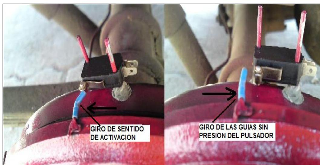
Figura 4.6 Sentido de activación del pulsador final de carrera.
