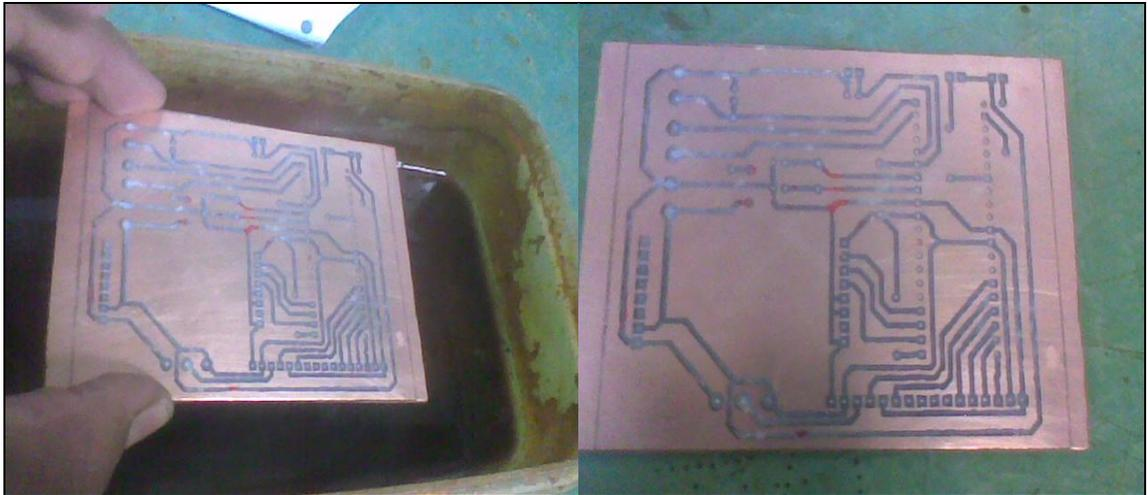
Figura 4.9 Resultado final de la placa electrónica.
