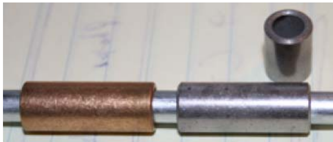
Figura 2.14 Bocines de deslizamiento.
