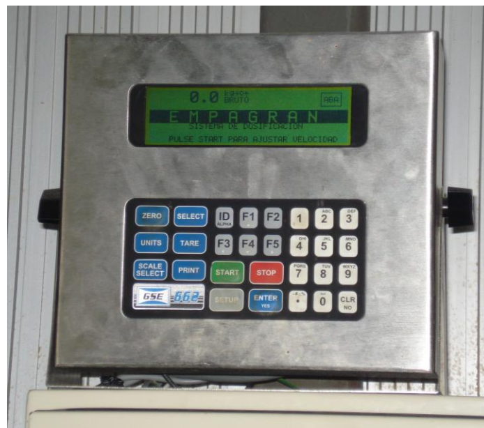
Figura 3.20. Menú para ajustar la velocidad de la bomba de aceite de pescado
