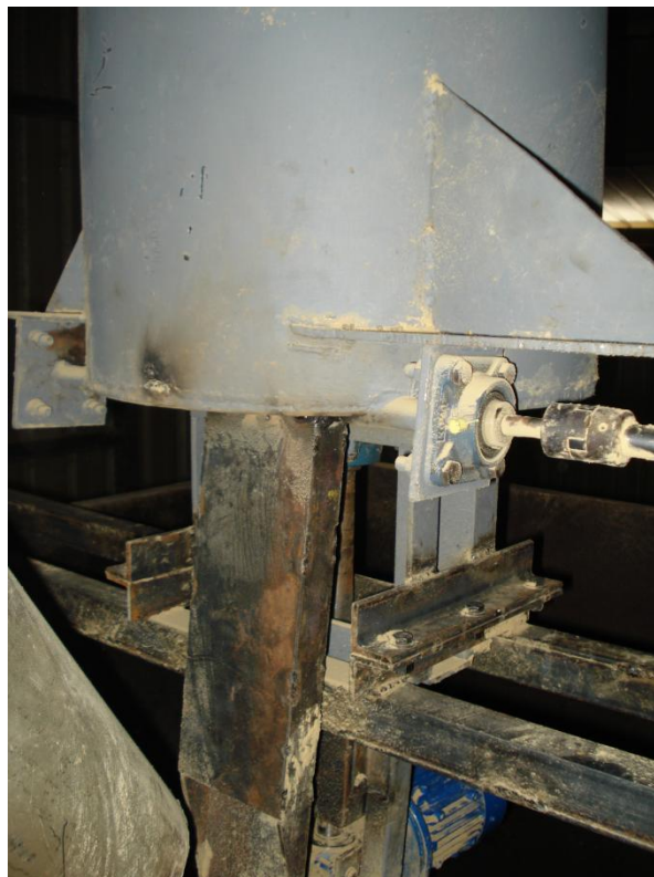
Figura 2.12. Ensamble del eje con las chumaceras
