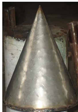
Figura 2.7. Construcción del cono de descarga
