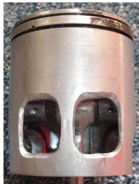
Gráfico 133 Ventanas de Admisión del pistón STD y Modificado
