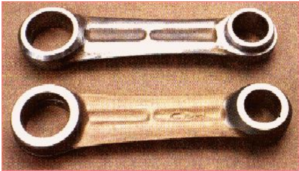
Gráfico 124 Aligeramiento de la biela
