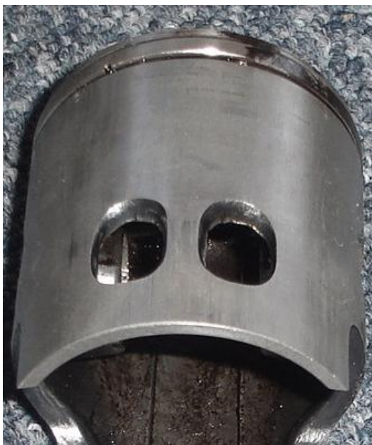
Gráfico 133 Ventanas de Admisión del pistón STD y Modificado
