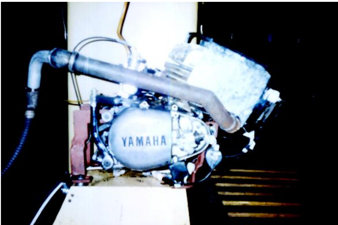
Gráfico 41 Vista Lateral del motor Acoplado en el banco de pruebas
