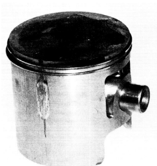
Gráfico 30 Avería de pistón por falta de engrase.
