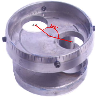
Figura 3.5 Localización de los agujeros espaciados a 120^\circ
