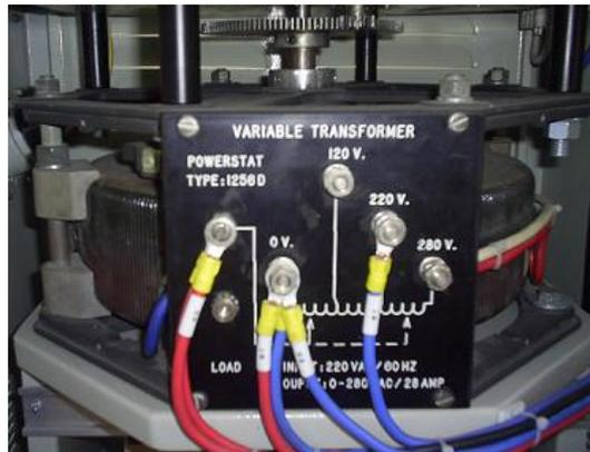
**Figura 4.8.- Variac utilizado en el equipo de pruebas de voltaje aplicado de ELEPCO S.A.**
