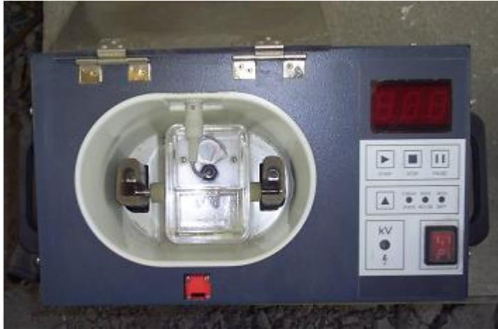
**Fig. 3.3. Equipo de pruebas de RD de aceite**
