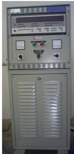
**Figura 3.5.- Equipo de pruebas de pérdidas en vacío y cortocircuito en transformadores de distribución**
