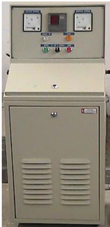
**Figura 4.11.- Vista del equipo para pruebas de voltaje aplicado para transformadores de distribución de ELEPCO S.A.**
