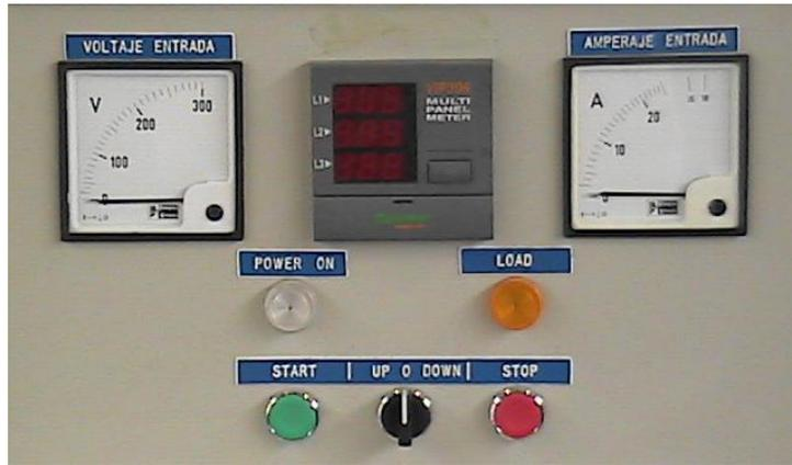
Figura 4.12.- Panel frontal de control y medida del equipo de pruebas de voltaje aplicado
