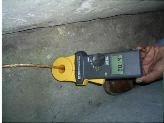
**Figura. 4.4.- Lectura final de resistencia de la malla de tierra**
