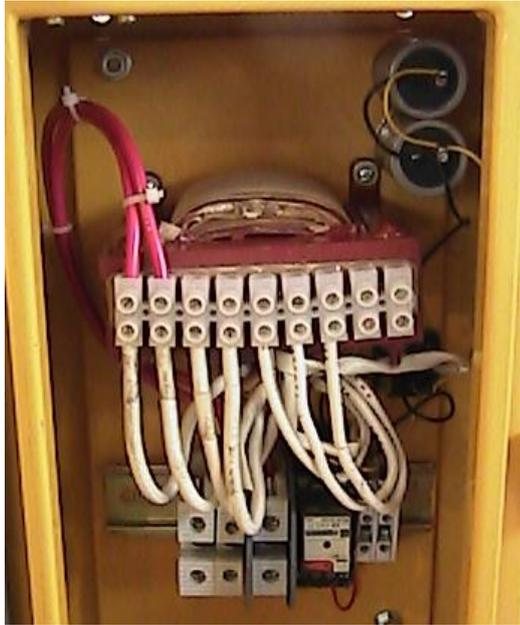
**Figura 4.10.- Circuito de protección para el caso de descarga**
