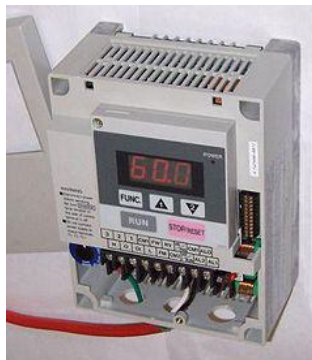
Figura 1.14 Variador de Frecuencia
