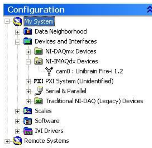
Figura 3.08 Selección de dispositivo a configurar en MAX
