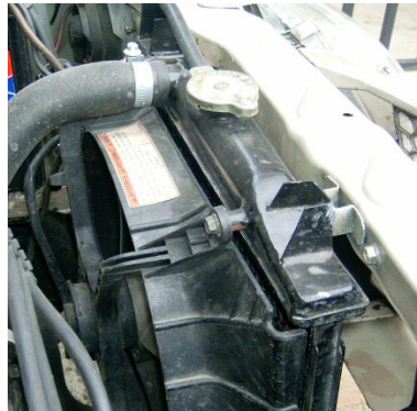
Figura 1.6.- Ventilador y radiador
