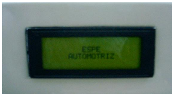
Figura 4.3.- Instalación de la pantalla de cristal liquido LCD
