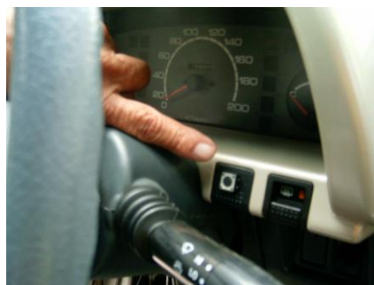
Figura 4.7.- Instalación del pulsador para seleccionar parámetro a monitorear.
