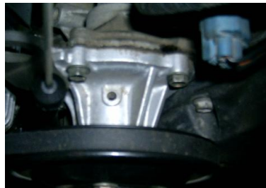
Figura 1.5.- Bomba de agua
