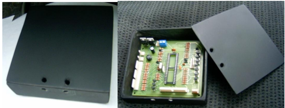
Figura 4.4.- Caja para la instalación de la placa de toda la circuitería electrónica.
