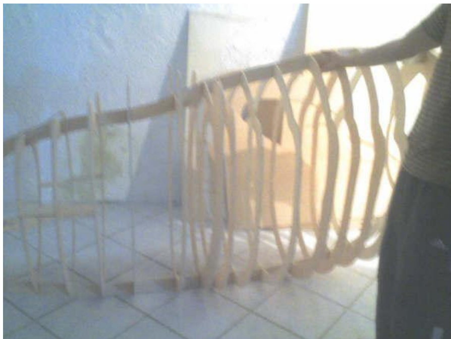
Figura 5.14.- Montaje de la estructura soporte de madera.
