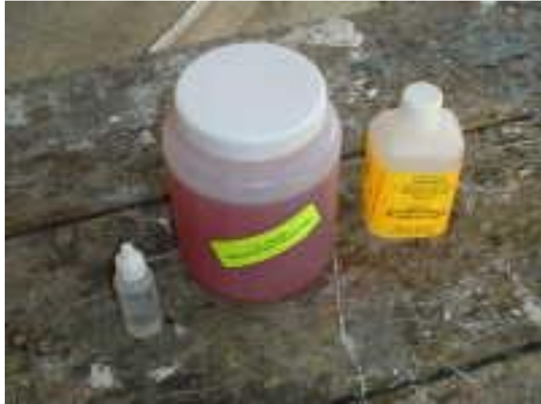
Figura 4.24. De izquierda a derecha, cobalto, resina de poliéster, catalizador
