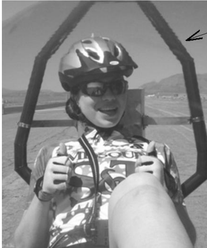
Figura 2.27 RollBar para seguridad en caso de volcamiento
