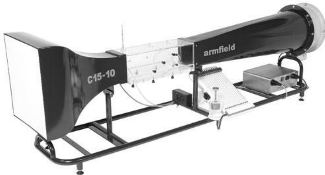
Figura 2.15 Túnel de viento para modelos a escala
