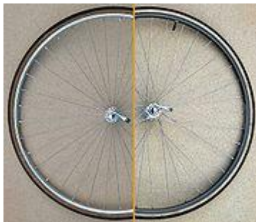
Figura 2.20 Radios anclados radialmente y anclados tangencialmente
