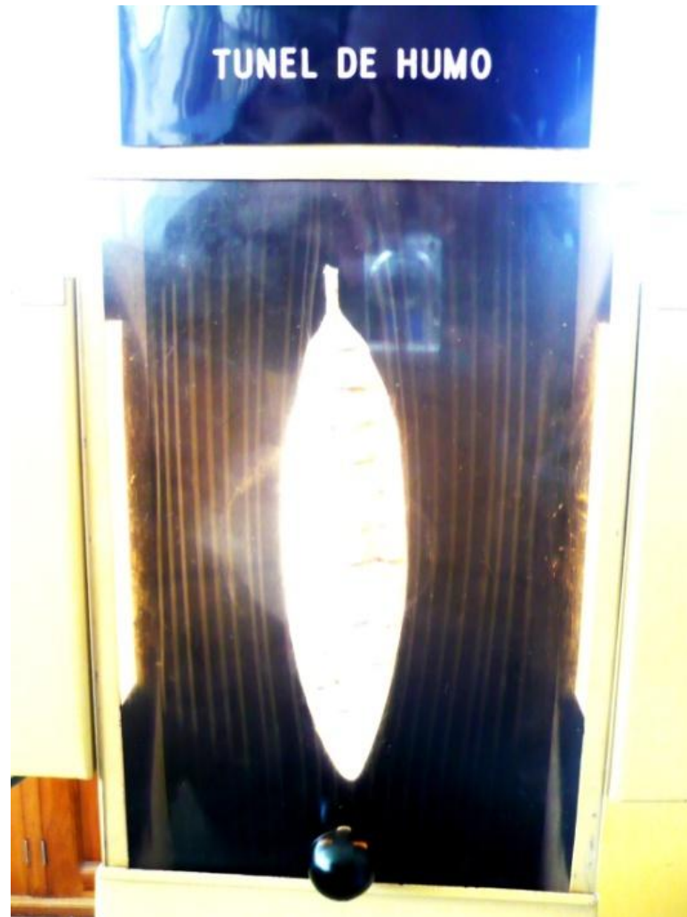
Fig.5.32 Líneas de Flujo en túnel de humo
