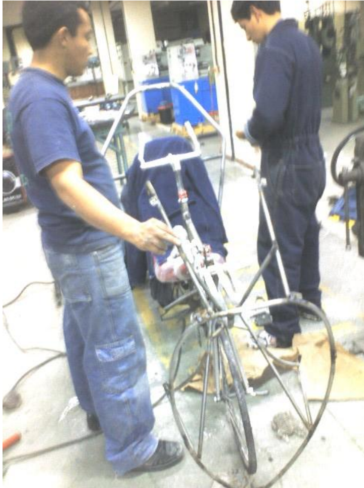
Figura 5.26. Fijación del soporte del carenado en el cuadro del vehículo
