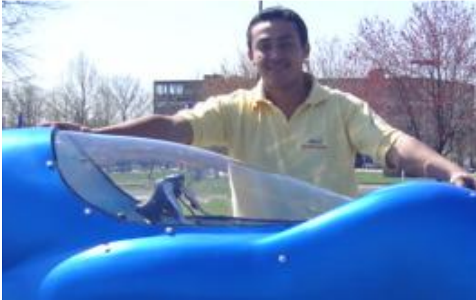
Figura 5.29. Fijación del visor de acrílico en la abertura superior del carenado
