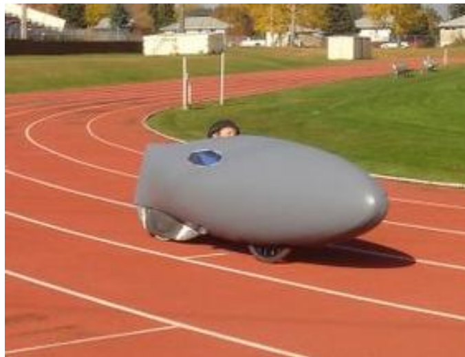
Figura 2.32 Carenado aerodinámico como medio de seguridad
