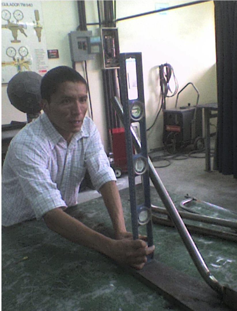
Figura 5.2.- Doblado y configuración del cuadro
