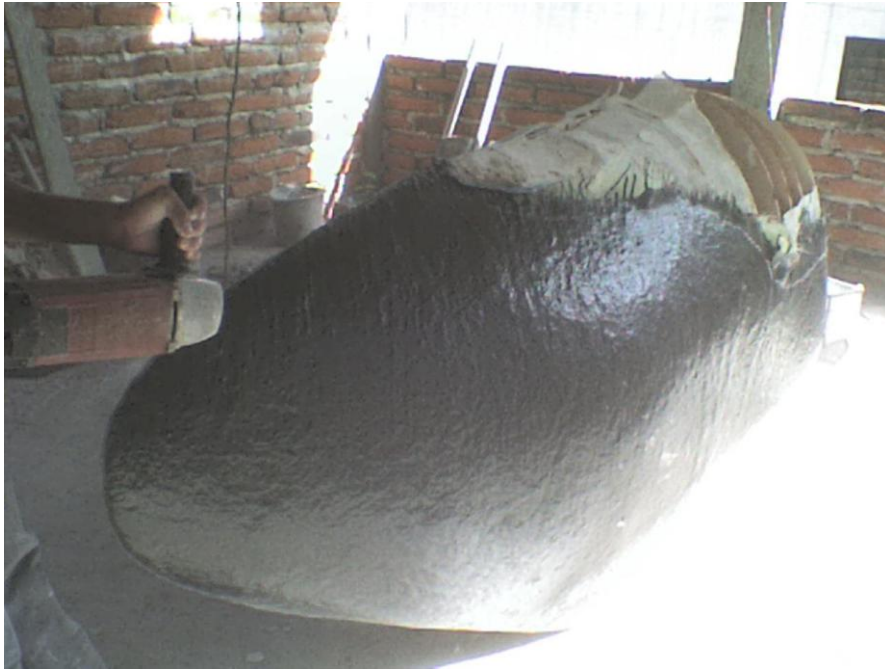
Figura 5.22. Corte del negativo de la fibra de vidrio
