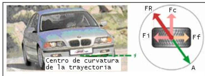
Figura 1.9. Fuerzas existentes en las frenadas en curva.
