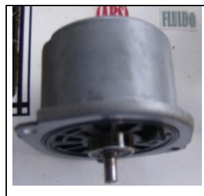
Figura 2.8. Motor de la bomba
