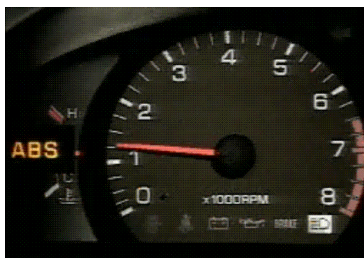
Figura 2.33. Tablero de instrumentos con luz ABS.
