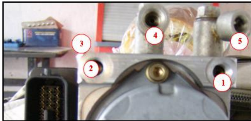
Figura 2.10. Entradas eléctricas e hidráulicas del EHCU
