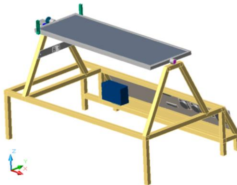
Figura 3.21 Disposición de la Batería
