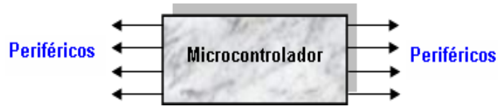
Figura 1.50 Estructura de un sistema abierto basado en Microcontrolador.
