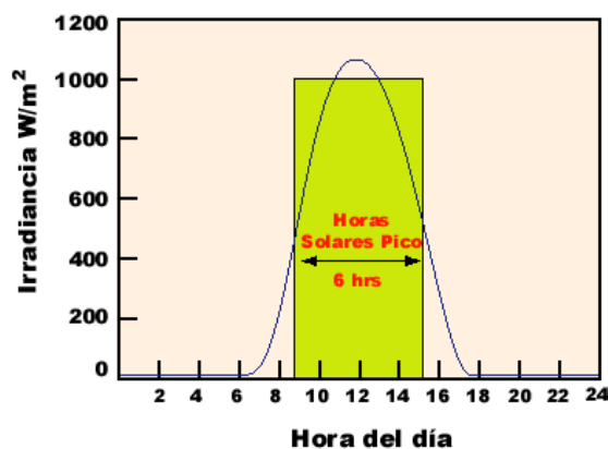
Figura 1.2 Irradiancia y horas solares Pico durante día soleado
