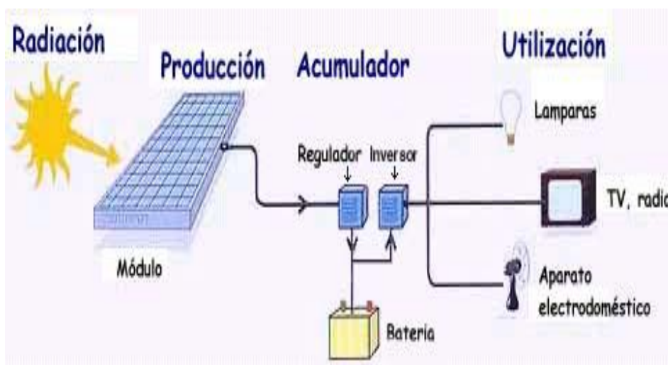
Figura 1.15 Instalación Solar fotovoltaica con Inversor para conexión a Red Vca.
