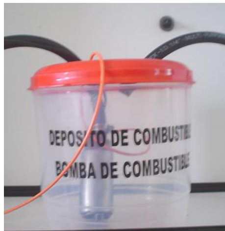
Figura 4.7 Deposito de combustible.
