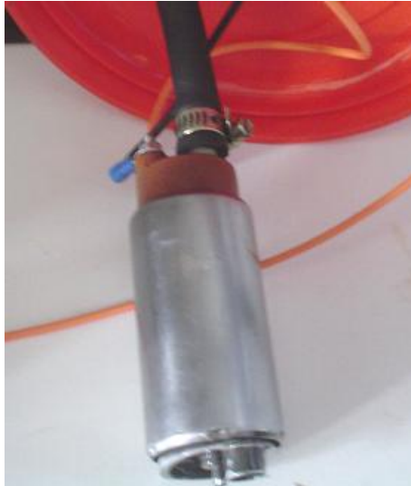
Figura 4.8 Bomba de combustible
