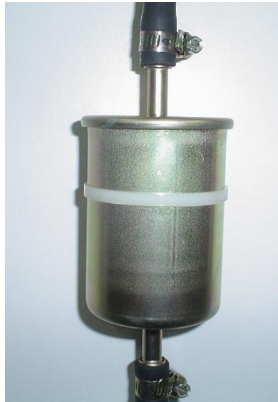
Figura 4.9 Filtro de combustible.
