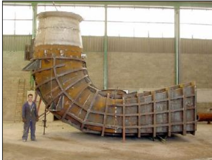
Figura 2.15. Tubo de succión construido y listo para el montaje.
