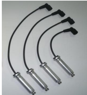
Figura 3.10.- Cables de alta tensión Tomado de Manual del Corsa
