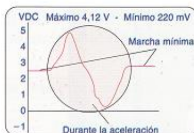
Figura 2.65.- Señal osciloscopio, sensor MAP Tomado de Manual Técnico de Fuel Injection
