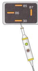
Figura 2.35.- Test 1, relé de la bomba Tomado de Manual Técnico de Fuel Injection
