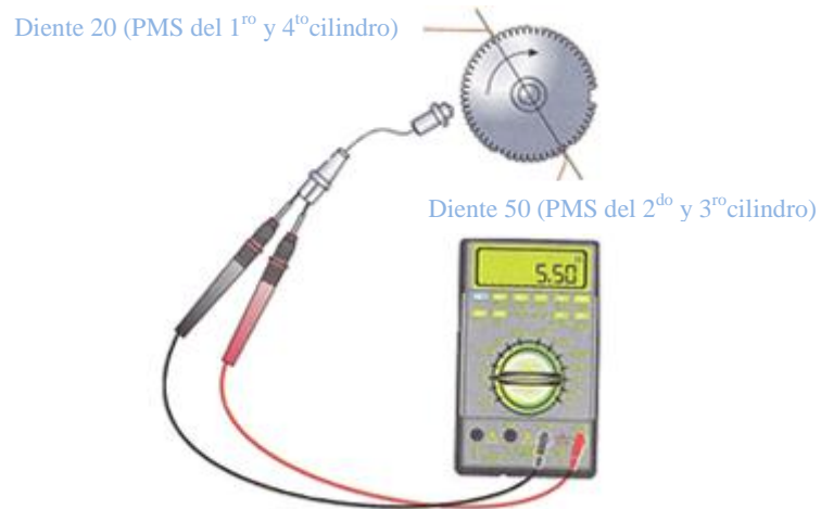
Figura 2.12.- Test 1, sensor CKP Tomado de Manual Técnico de Fuel Injection
