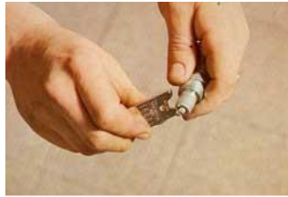
Figura 3.18.- Limpieza de una bujía
