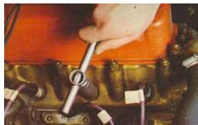
Figura 3.16.- Extracción de una bujía
