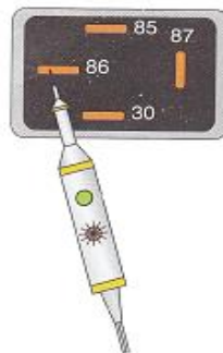
Figura 2.36.- Test 2, relé de la bomba Tomado de Manual Técnico de Fuel Injection
