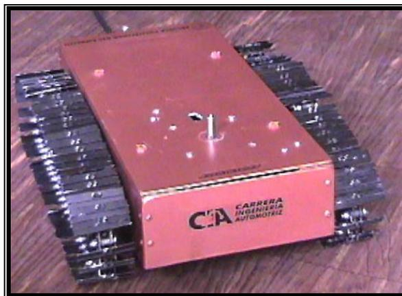
**Figura 2.1. - Bastidor de la Oruga**
