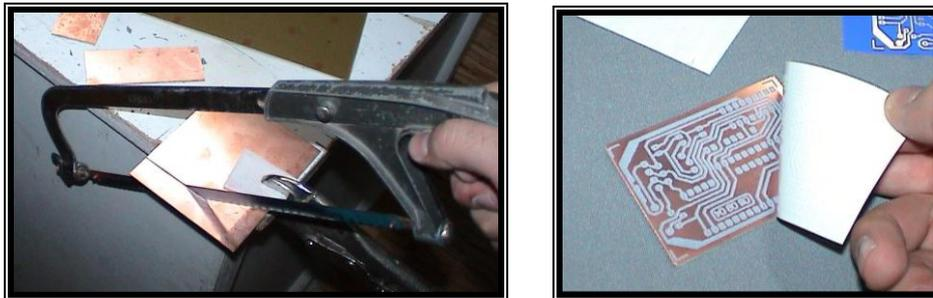
**Figura 3.25. - Corte e Impresión de la Baquelita**
