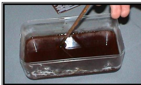
**Figura 3.26. - Baquelita Sumergida en Acido Férrico**
