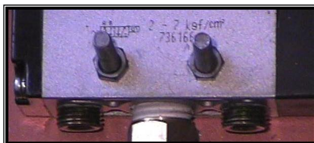
Figura 3.30. - Sujeción de la Válvulas con Tornillos
