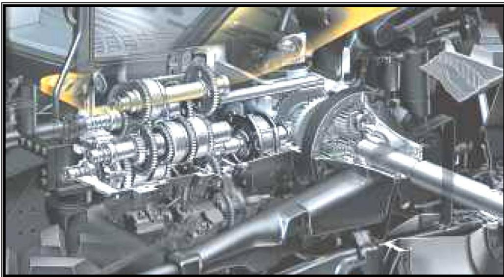
**Figura 1.6. - Sistema de Engranajes del Tren de Potencia**
