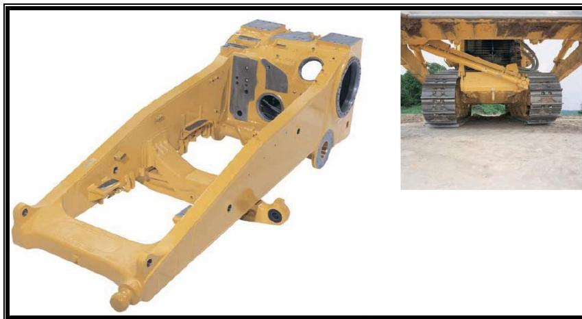
**Figura 1.4. - Bastidor Central**
