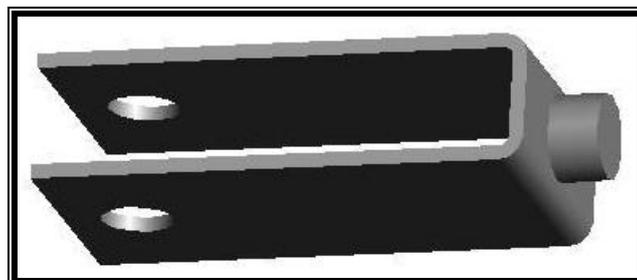
**Figura 3.8. - Soporte del piñón Tensor**
