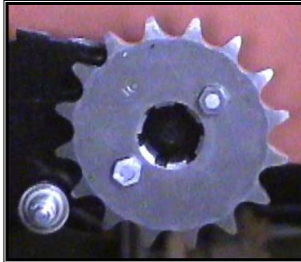
**Figura 3.7. - Montaje del Bocín en el eje y sujeción**
