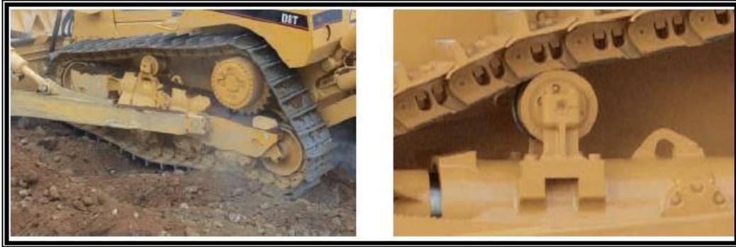
**Figura 1.10. - Oruga Típica de Tractor**
