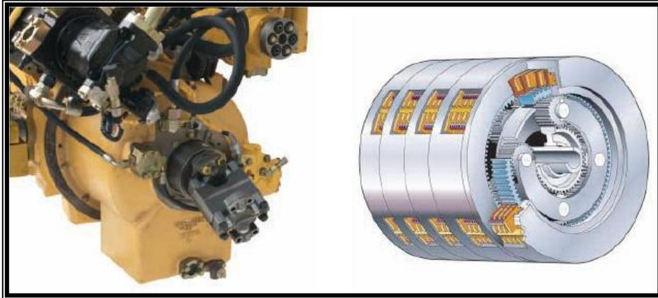
**Figura 1.27. - Detalle de Engranaje Planetaria**
