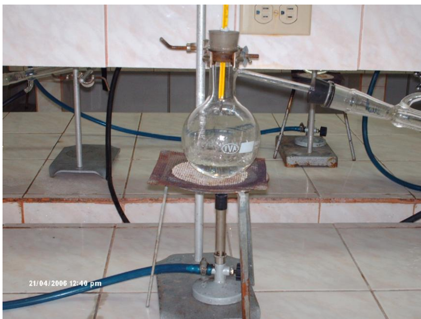
Fig. 2.8 Punto de ebullición del alcohol
