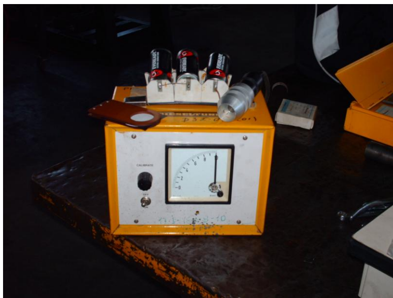
Fig.4.6 Opacímetro utilizado para el análisis.
