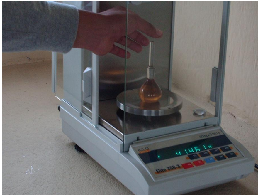
Fig.2.29 Medición de la peso
