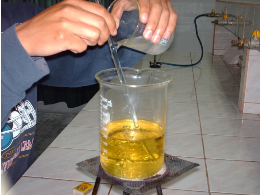
Fig.2.13 preparación del metóxido de sodio
