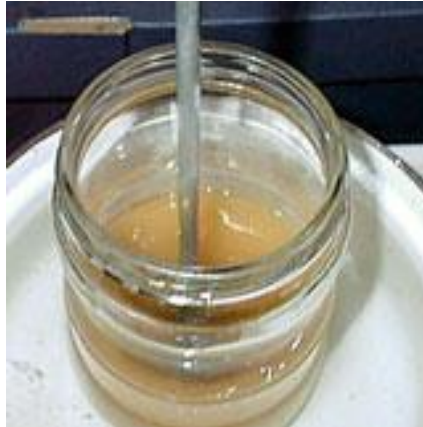
Fig.1.7 Suspensión formada después de añadir el metanol.
