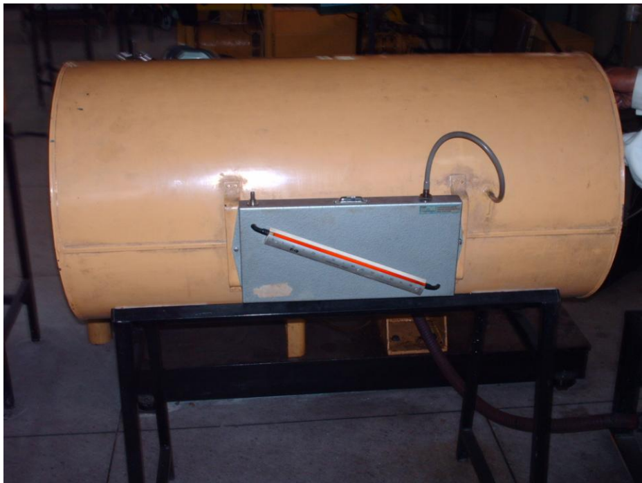
Fig.3.5 Medición de la temperatura del aire
