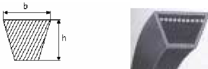
Figura 1.24 Sección transversal de una correa trapezoidal
