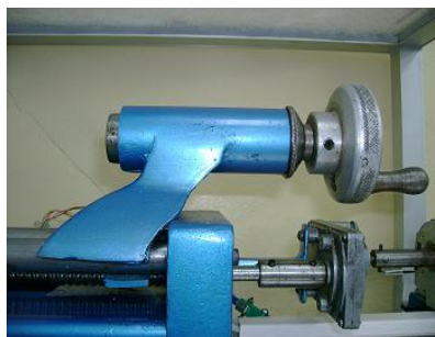
Figura 4.3 Montaje de la estructura del Cabezal móvil
