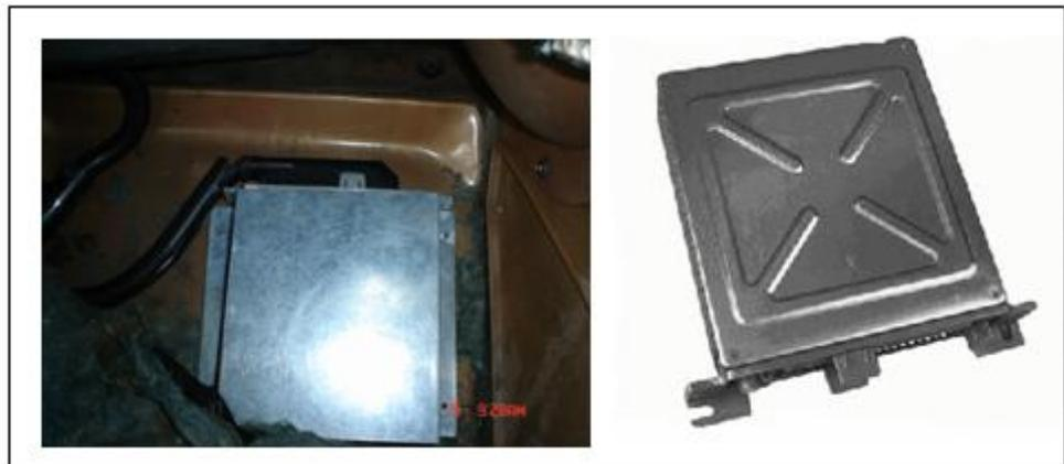
**Figura 2.4 Posición de la ECU en el vehículo.**
