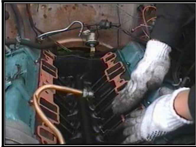
**Figura 3.7 Colocación de empaques de admisión**
