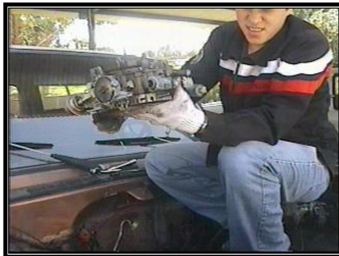
**Figura 3.4 Desmontaje del carburador**
