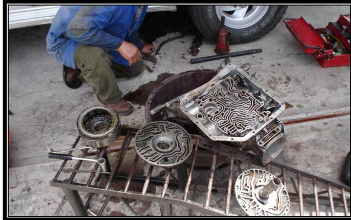
**Figura 3.3 chequeo de transmisión automática**
