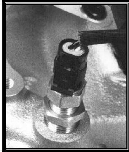
**Figura 3.25 Instalación del sensor ECT**
