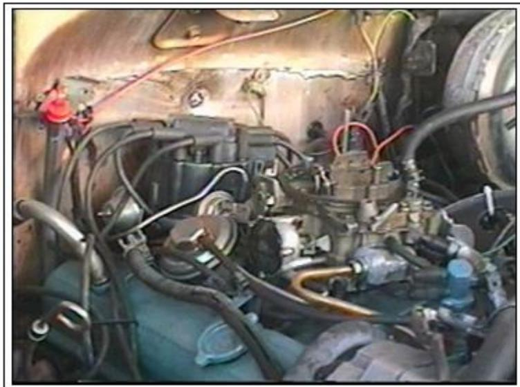
Figura 1.1 Motor GMC a carburador.
