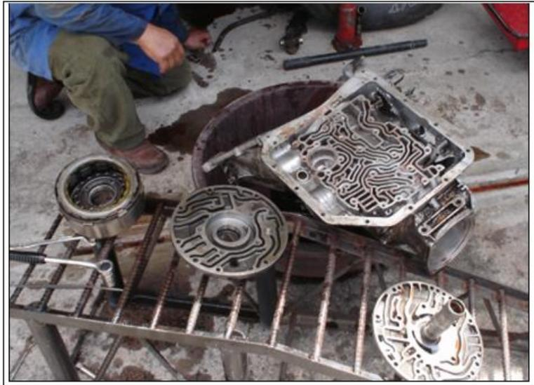
**Figura 2.2 Revisión de la caja automática.**
