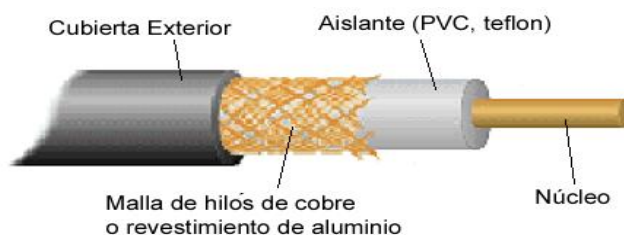
Figura 1.19 Estructura de un cable Coaxial.
