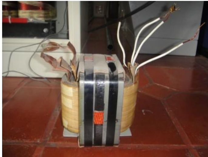
Figura 4.6 – Transformador de baja tensión para pruebas
