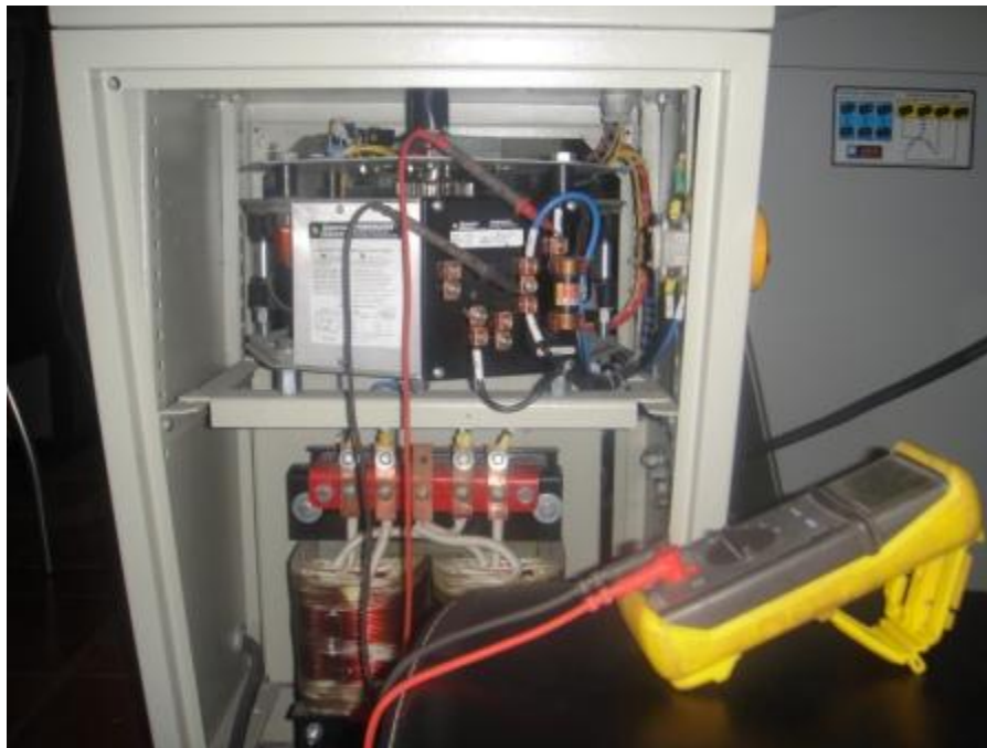
Figura 4.1 – Conexión de multímetro a VARIAC
