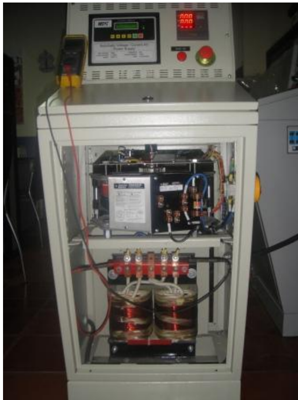
Figura 4.2 – Conexión de multímetro al transformador de aislamiento
