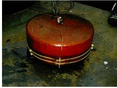
Figura 3.30 RTD Pt 100 instalada en boya de nivel
