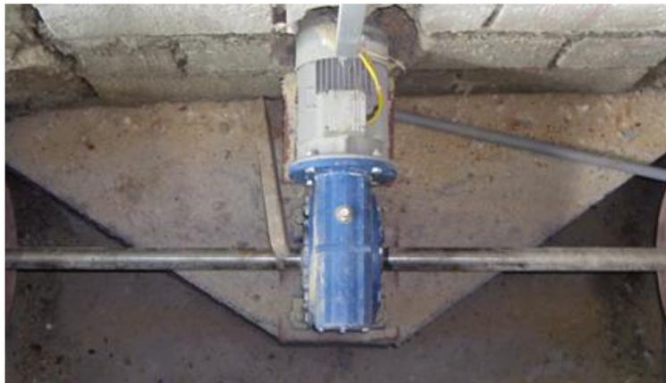
Figura 3.9 Acoplamiento del Eje
