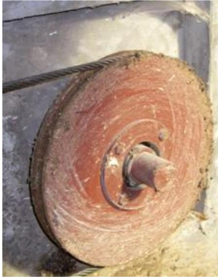
Figura 3.13 Empotramiento del Eje y la polea
