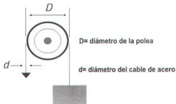
*Esta es una relación de extrema importancia en muchos aspectos del estudio de los cables de acero. Mide la curvatura del eje de un cable en relación con su propio diámetro.*
