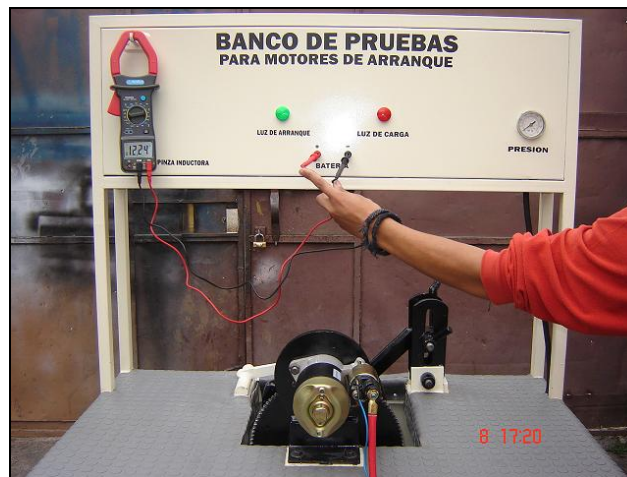
Figura 4.5 Voltaje de la batería
