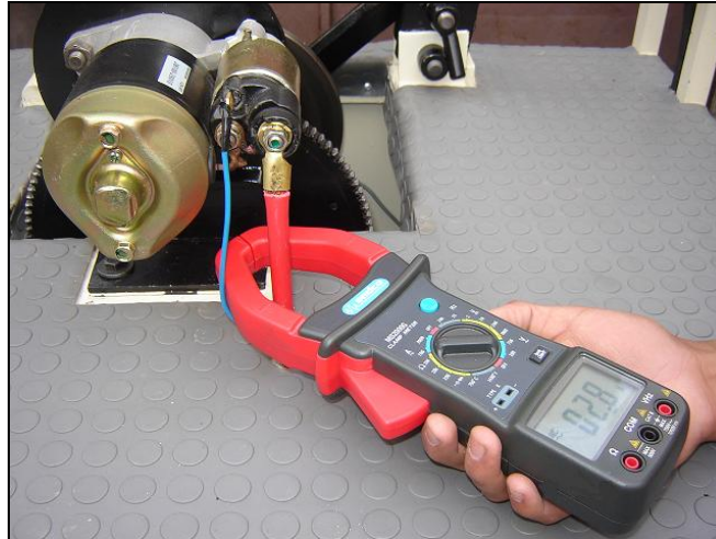
Figura 4.4 Determinación de corriente
