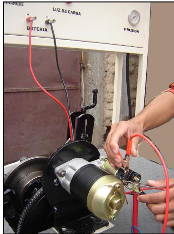
Figura 4.8 Prueba de empuje del piñón
