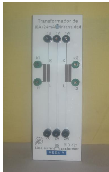
Figura 2.12: Transformador de corriente
