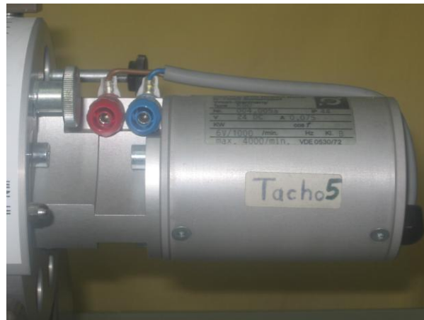
Figura 2.13: Tacogenerador instalado en la mesa de trabajo.
