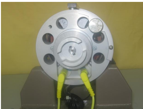
Figura 2.14: Sensor de torque de tipo resistivo.
