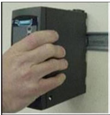
**Figura 5.19 Montaje del variador**
