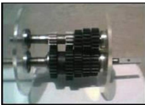
**Figura 5.15 Montaje de los ejes en la carcasa**
