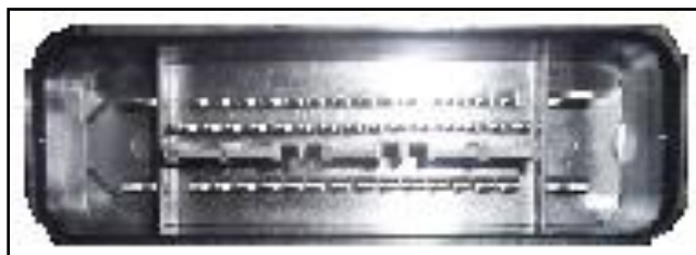
Figura 1.32 Identificación de los bornes del enchufe del módulo de control del ABS.
