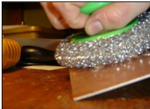
Figura 3.26 Limpieza de las placas
