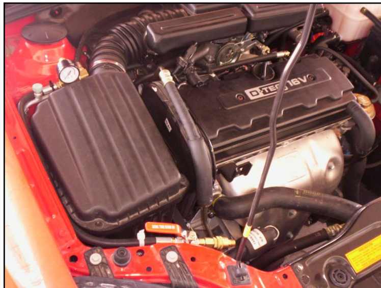
Figura 4.14 Instalación manómetro de presión
