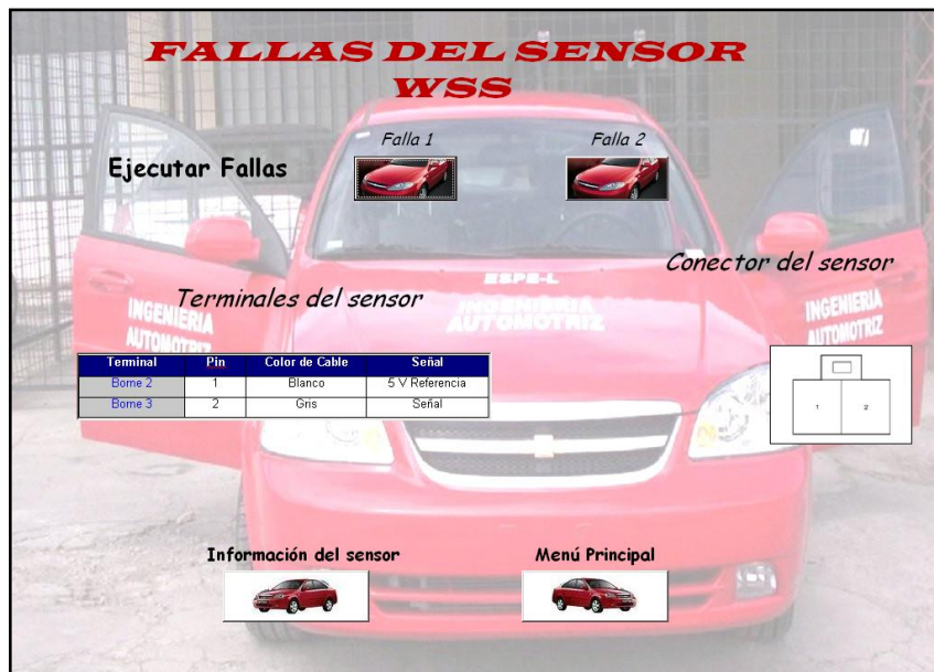
Figura 4.51 Pantalla de fallas del sensor WSS
