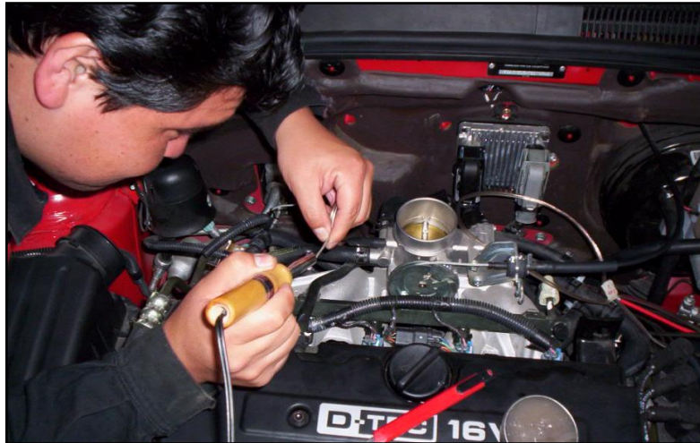
Figura 4.5 Corte y soldado de cables en el vehículo
