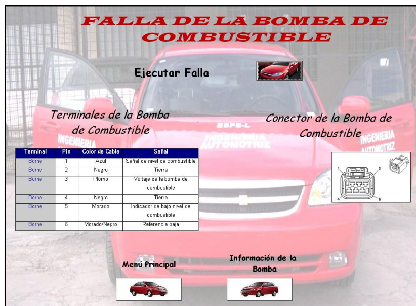
Figura 4.42 Pantalla de fallas del actuador bomba de combustible
