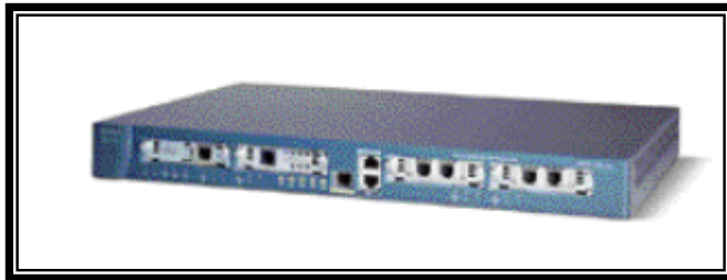
Figura 3.13 Router 1760 CISCO de Acceso Modular
