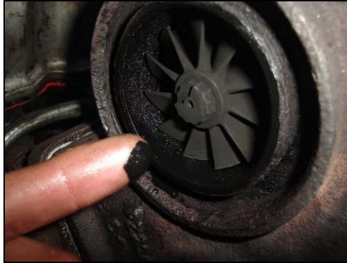
Figura 4.14 Turbo en malas condiciones.
