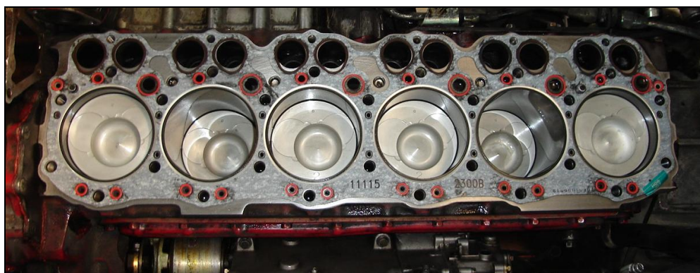
Figura 2.38 Colocación del empaque de cabezote.
