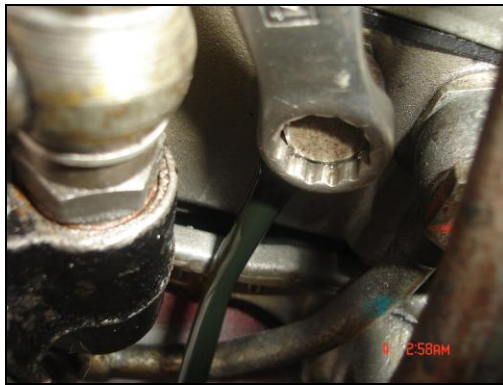
Figura 4.6 Comprobación de la lubricación a la bomba de inyección.
