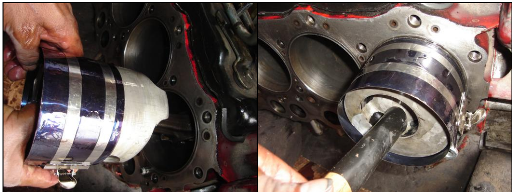
a. Colocación del pistón.
