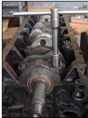
Figura 2.18 Asentado de los cepos de bancada
