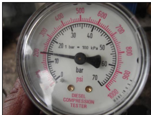
Figura 4.11 Lectura de compresión del motor.
