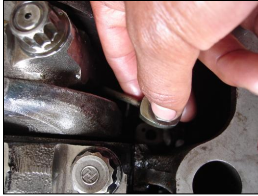
Figura 2.27 Instalación de salpicadores.
