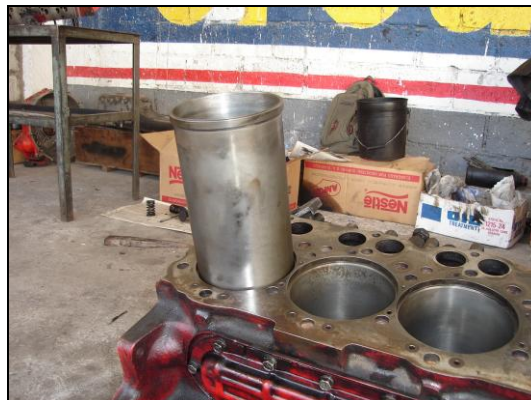
Figura 2.1 Motor con camisa tipo Seco.
