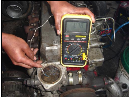
Figura 4.8 Comprobación de la temperatura del refrigerante.
