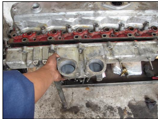
Figura 2.36 Adaptación del múltiple de admisión.
