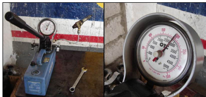
Figura 2.33 Calibración de inyectores.
