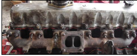
Figura 2.35 Adaptación del múltiple de escape.
