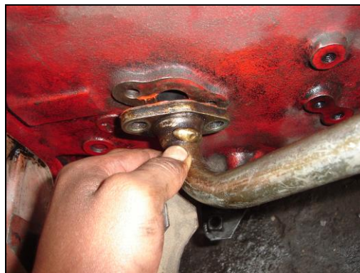
Figura 3.16 Instalación del bufle de aire.
