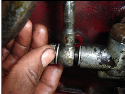
Figura 3.13 Instalación del conducto de lubricación.
