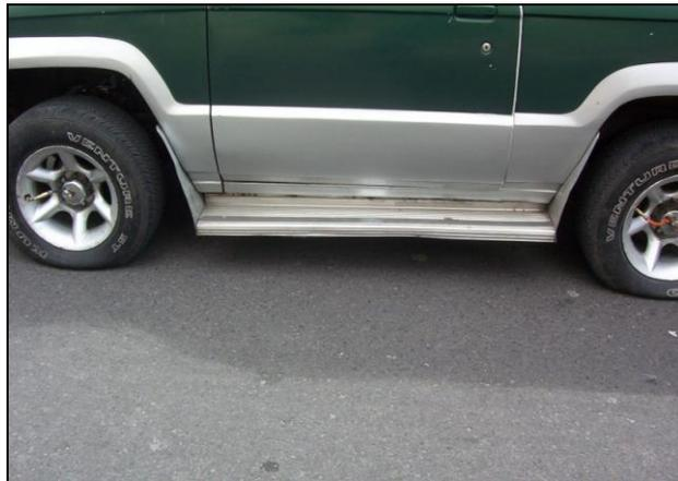
Figura 4.6 Pérdida de presión en los neumáticos derecha delantero y posterior
