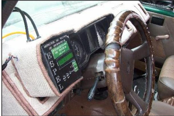
Figura 3.23 LCD instalado en el tablero
