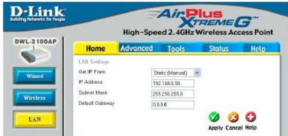
Fig. 3.19 Configuración D LINK (Home LAN)
