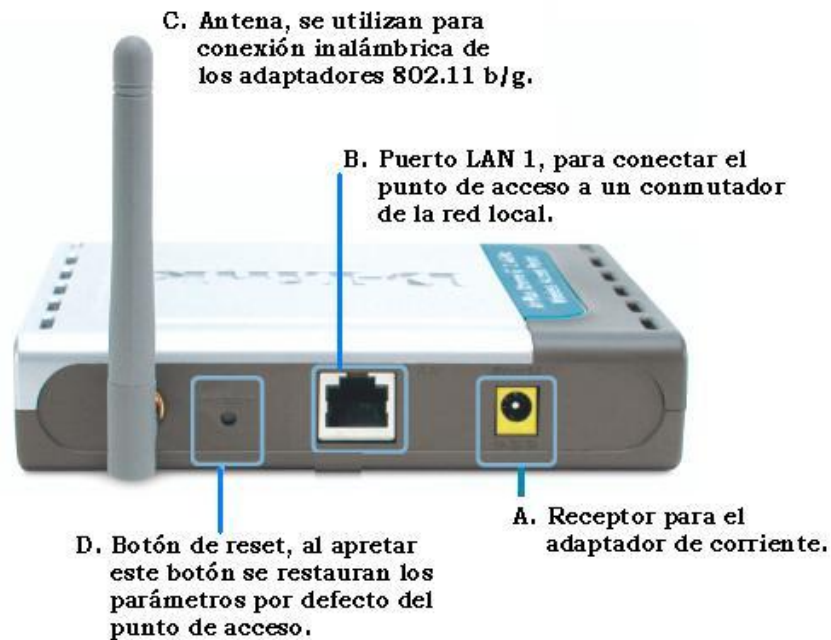
Fig. 3.17 Partes del Access Point
