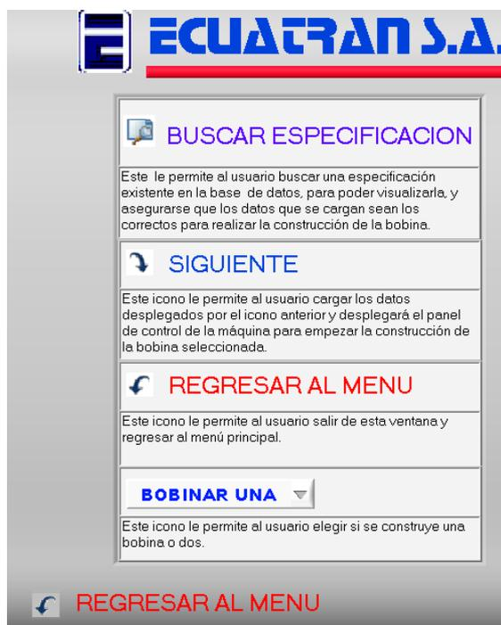
**FIGURA No. 4.16 Ayuda de Panel Frontal para seleccionar la Especificación**
