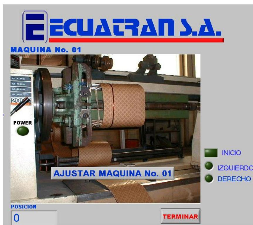
FIGURA No. 4.8 Panel Frontal para el Ajuste de la Máquina
