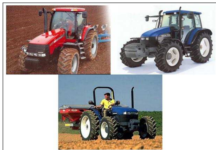
Figura 2.2 Tractor de ruedas neumáticas, estándar, doble tracción
