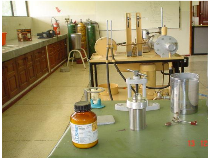
Figura 4.18. Realización de la muestra del ácido benzoico.
