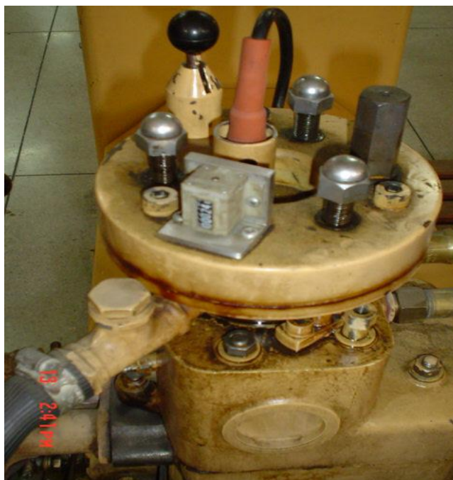
Figura 4.13 variación de la relación de compresión
