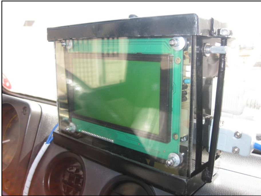
Figura 4.5: Pantalla GLCD montada sobre el tablero del vehículo
