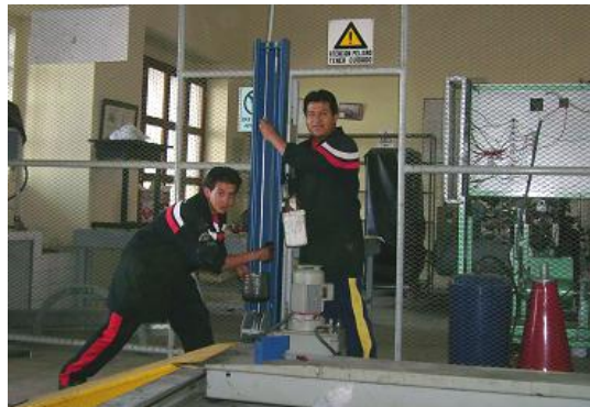
Figura 6. 76. Limpieza del polvo y otros residuos en la columna
