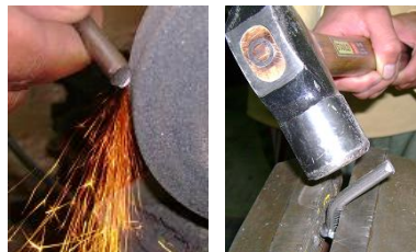
Figura 6. 19. Construcción del pasador
