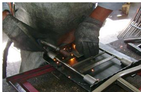
Figura 6. 29. Reparación de las guías
