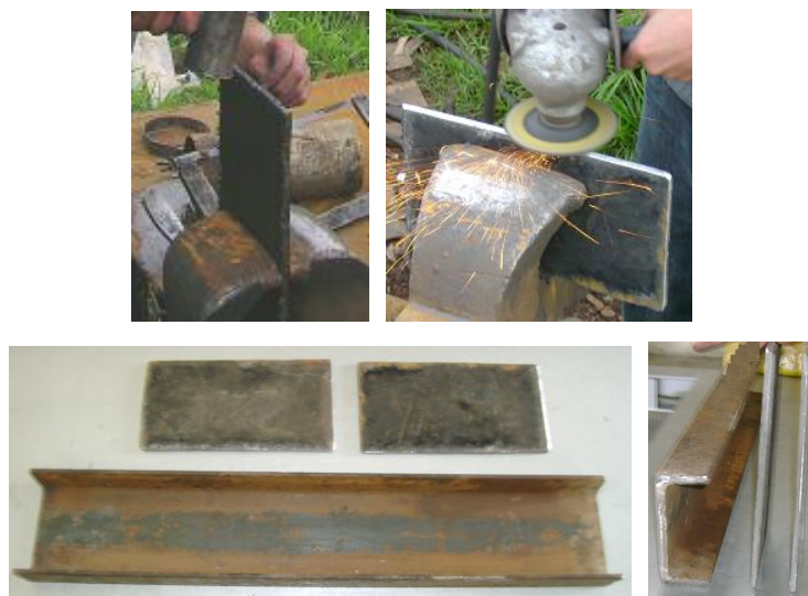
Figura 4.5. Pulido placas laterales y riel principal
