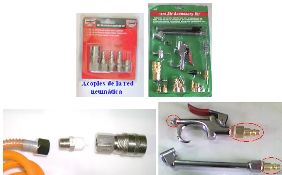
Figura 5.17. Colocación de los acoples
