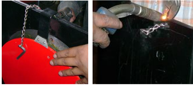
Figura 6. 21. Soldado del pasador en los tornamesas delanteras y traseras
