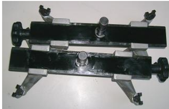
Figura 6. 47. Abrazaderas de auto centrado totalmente reparadas
