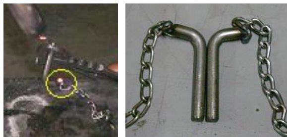
Figura 6. 20. Soldado y terminado del pasador
