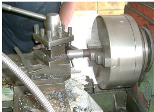
Figura 6. 27. Construcción del rodillo faltante
