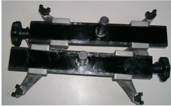
Figura 6. 40. Abrazaderas de auto centrado ya reparadas
