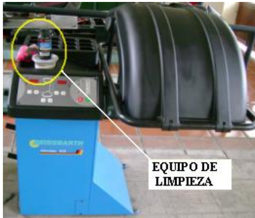
Figura 6. 49. Limpieza de la balaceadora
