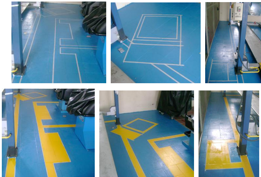
Figura 5. 45 Señalización de zonas de seguridad
