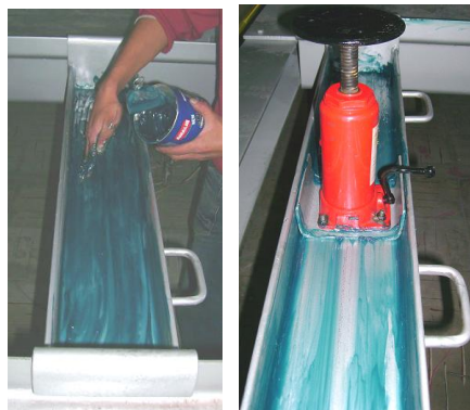
Figura 6.102. Lubricación guía interna puente corredizo
