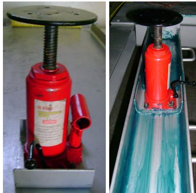
Figura 4.19. Ensamblaje de todo el conjunto puente corredizo y gato hidráulico
