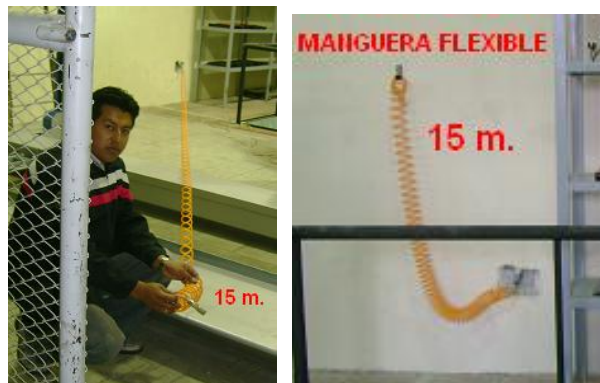
Figura 5. 18. Colocación de la manguera flexible
