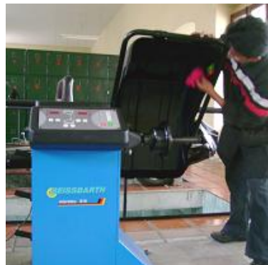
Figura 6. 59. Limpieza del cáster protección de rueda
