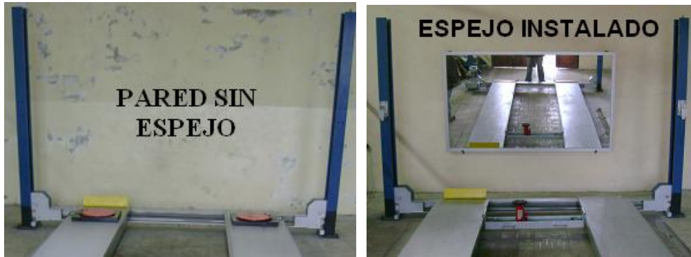
Figura 5. 20. Instalación final del espejo
