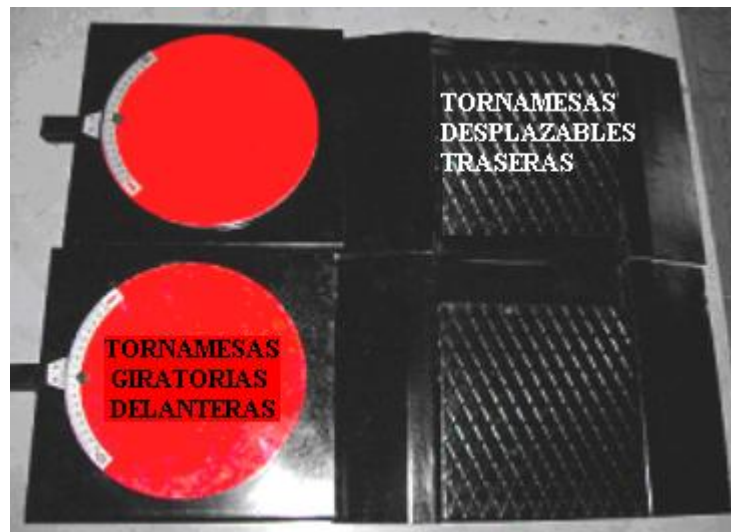
Figura 6. 48. Tornamesas totalmente reparadas traseras
