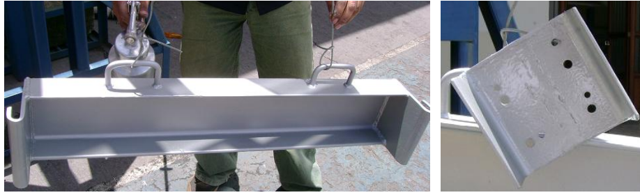
Figura 4.18. Pintura general conjunto puente corredizo
