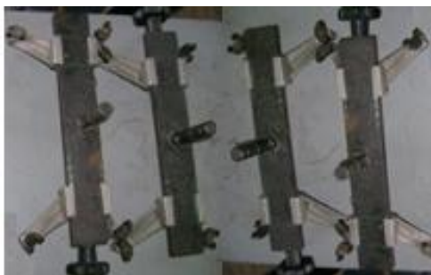
Figura 6. 32. Abrazaderas de auto centrado deterioradas
