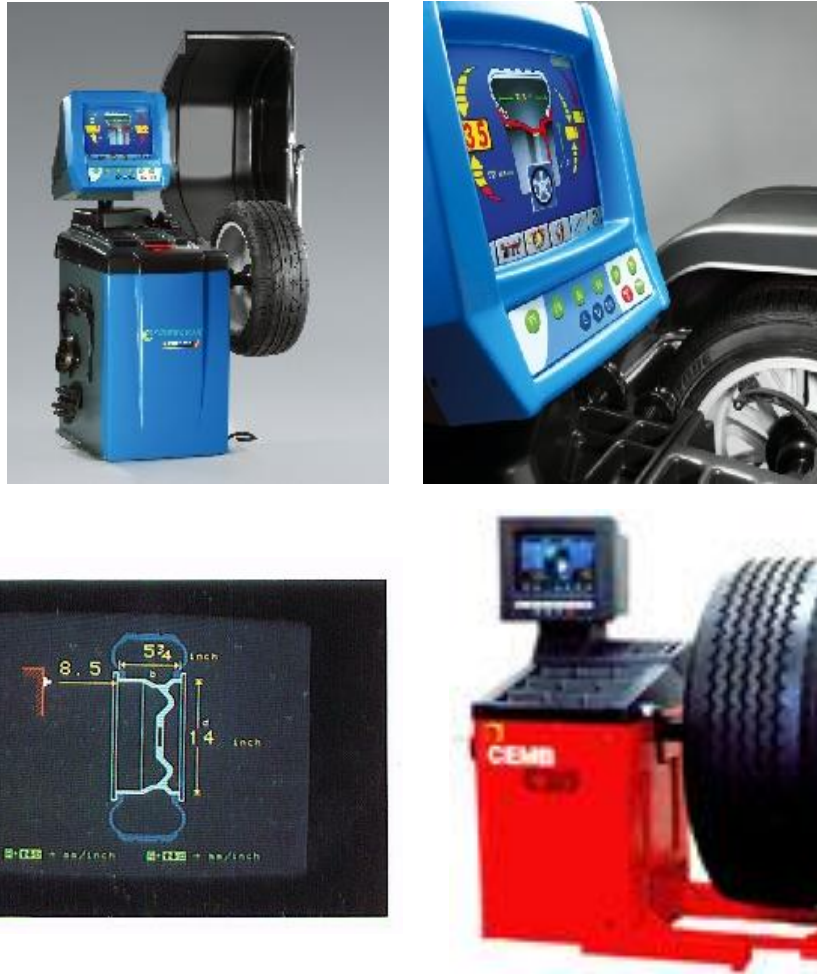
Figura 3.11. Equipo de Balanceo con Ilustraciones en 3D
