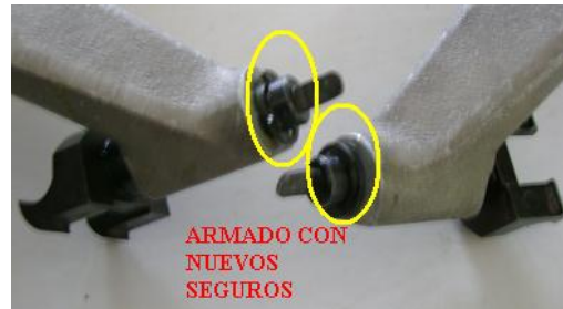
Figura 6. 38. Colocaciones de nuevos seguros
