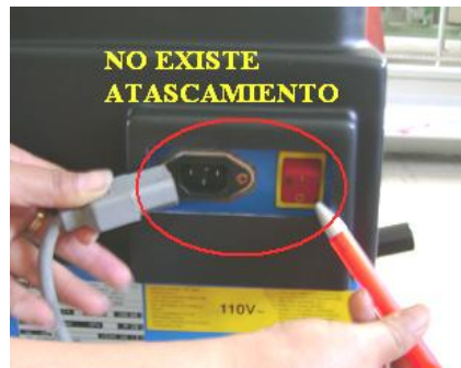
Figura 6. 53. Revisión del estado del interruptor
