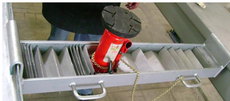
Figura 4.21. Colocación de cadena de seguridad
