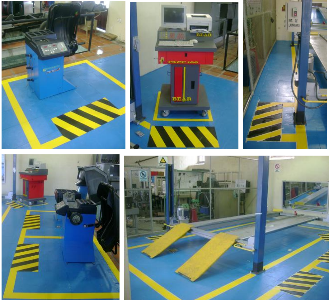
Figura 5. 45 Señalización de zonas de operación
