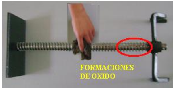
Figura 6. 43. Limpieza total del depresor de volante
