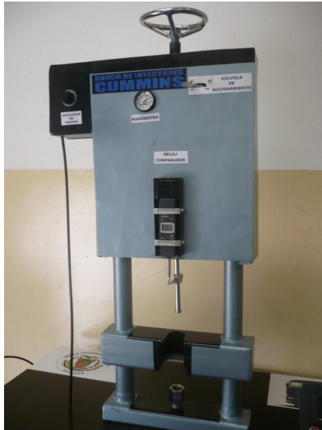
Banco de calibración terminado.
