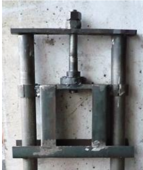
Figura 5.48. Mecanismo de regulación de la altura del cilindro.
