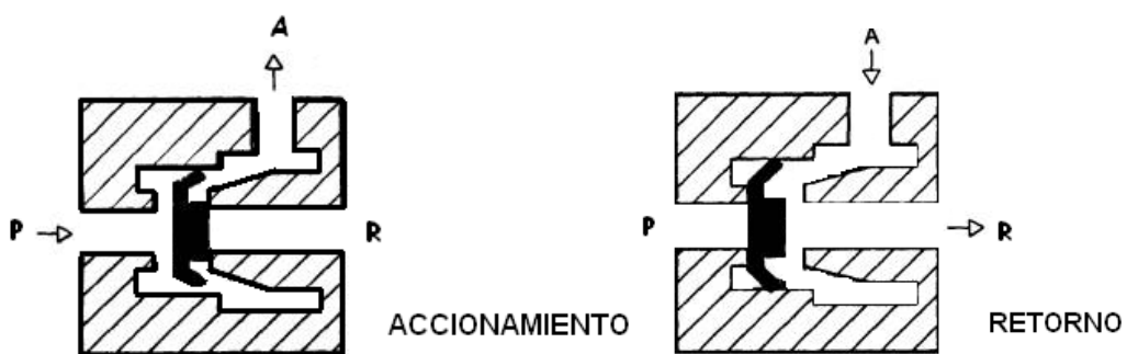
Figura 5.24. Funcionamiento de la válvula de escape rápido.
