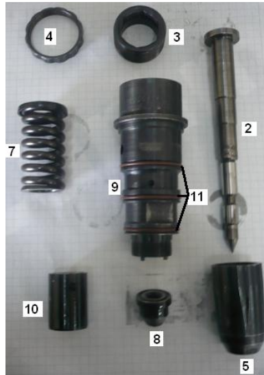
Figura 6.4. Elementos del inyector Top Stop.
