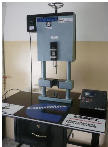
Figura 5.54. Banco de calibración Cummins terminado.
