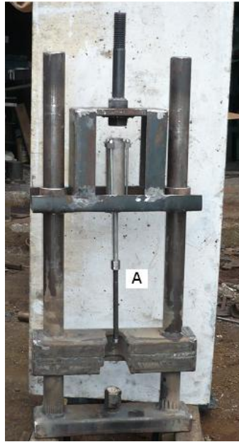
Figura 5.49. Mecanismo del cilindro neumático.
