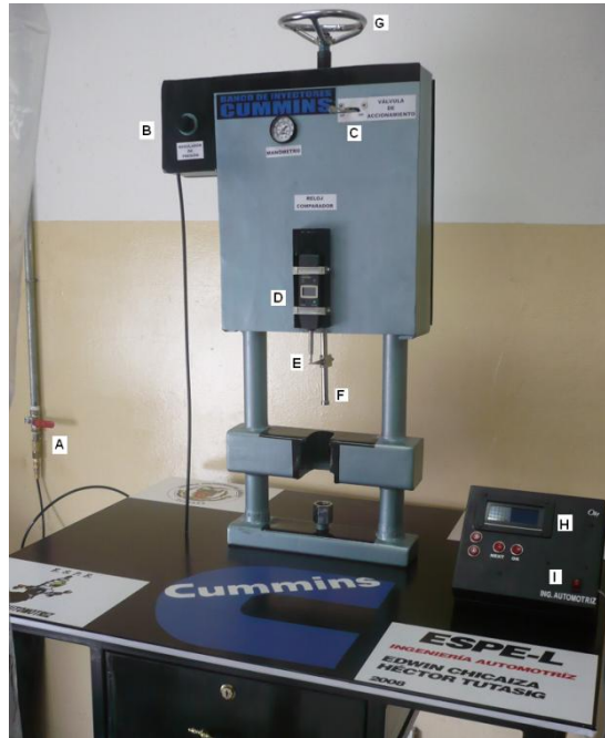
Figura 6.1. Prueba del banco de calibración.
