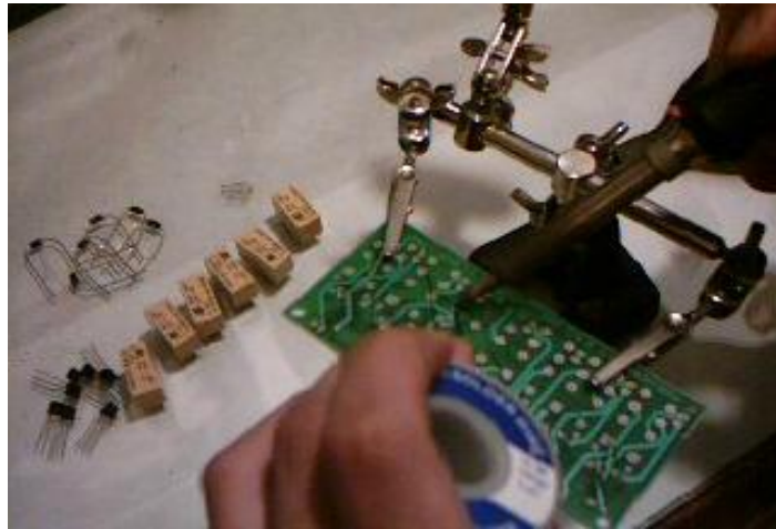
Figura 4.14. Montaje de elementos.
