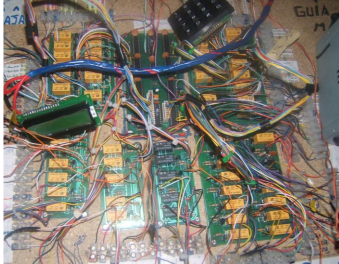
Figura 4.17. Conexión entre las placas.
